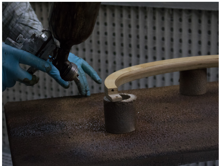
figura 123. Aplicação de Verniz acetinado incolor numa base giratória.
