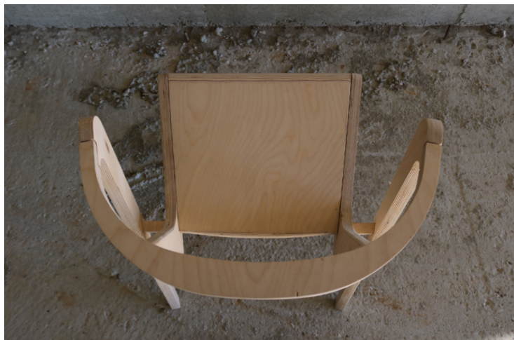
figura 104. Detalhe referente à orientação e disposição das pernas da cadeira.
