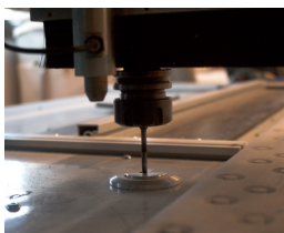
figura 96. Calibração da fresa.
