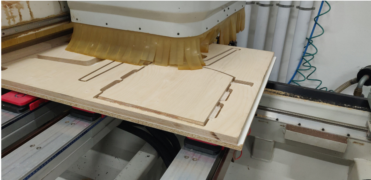
figura 110. Primeiras tentativas de maquinação, período de duração: 24 minutos.
