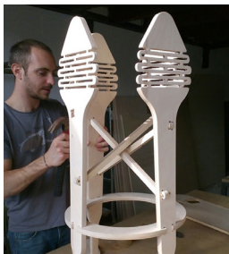
figura 44. Felix de Franco Raggi, método de articulação das pernas de maneira a sustentar o assento.
