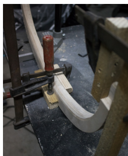
figura 114. Fixação das peças através de grampos.
