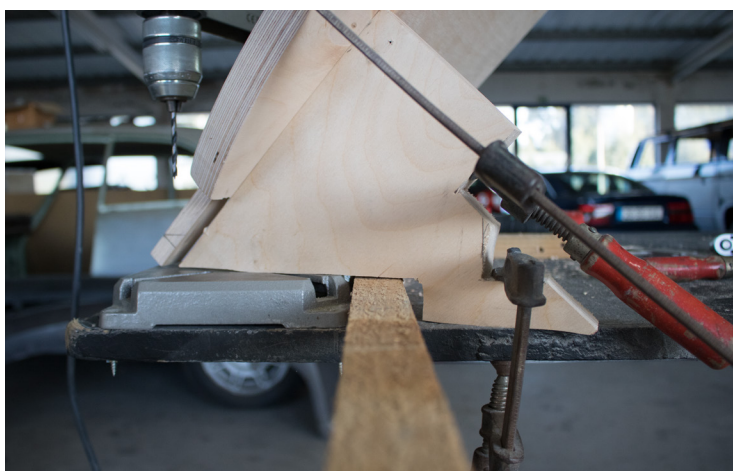
figura 116. Elaboração de um suporte para o aperto da peça na posição desejada para efetuar o ato de furação.
