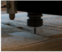
figura 97. Desbaste com a fresa de 8Ø.
