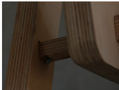
figura 106.a e 106.b Método de união entre três componentes, assento, perna dianteira e perna traseira. Pormenor do encaixe da perna dianteira e perna traseira com o apoio de braços.
