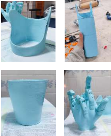
Figura 68 – Pintura, colagem e montagem dos componentes da prótese.
