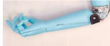
Figura 70 – Processo de montagem do antebraço e mão; furação do antebraço e passagem do cabo de controle.
