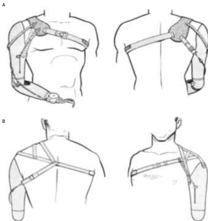
Figura 79 – A - Arnês de cinta torácica para amputações acima do cotovelo, com recurso a sela de couro. B – Arnês de cinta torácica para amputações acima do cotovelo, com recurso a correias (PURSLEY, 1955).
