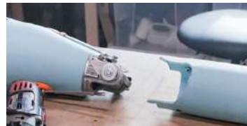
Figura 71 – Quebra do antebraço ao fazer a montagem da prótese.
