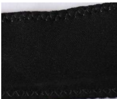
Figura 105 – Amostra de neoprene caseado com linha elástica.
