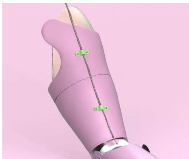
Figura 76 – Detalhes dos apliques de controlo do cotovelo
