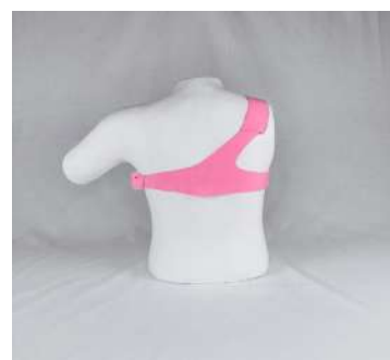
Figura 96 – Segunda maquete de arnês; Este é inspirado no arnês de cinta torácica que distribui melhor as tensões causadas pelo uso prolongado da prótese.
