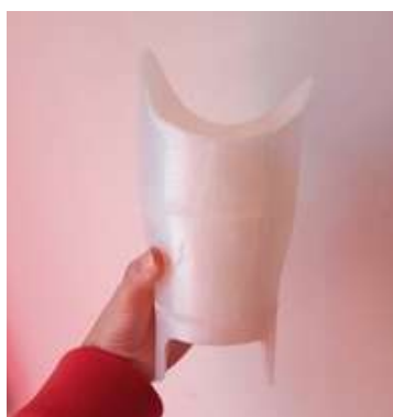
Figura 57 – Primeiro protótipo da interface entre o utilizador e a prótese; braço da prótese.
