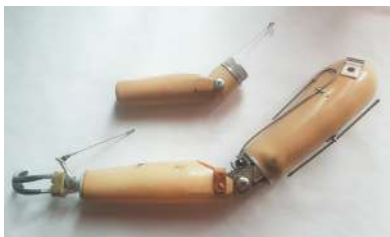
Figura 58 – Próteses Mecânicas fornecidas pela empresa P.O. Em cima - Prótese de criança. Em baixo - Prótese de adulto.
