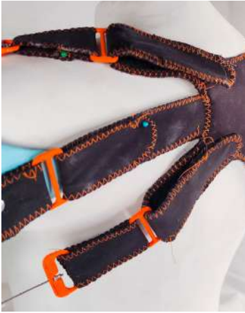
Figura 108 – Montagem do arnês na prótese.
