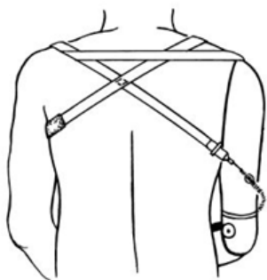
Figura 92 – Localização do tirante de fixação do sistema de controlo num arnês de figura oito (Bowker, 1992).
