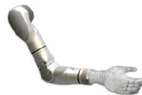
Figura 43 – Prótese mioelétrica disponibilizada pela empresa Ottobock.
