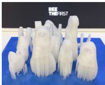
Figura 63 – Componentes da mão após impressão 3D.
