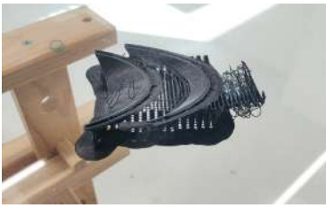
Figura 67 – Um dos erros ocorridos durante o processo de impressão 3D; neste caso houve um desnivelamento durante a impressão.
