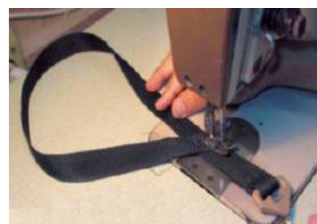
Figura 84 – Conformação do arnês com recurso a máquina de costura. (International Committee of the Red Cross, 2006).
