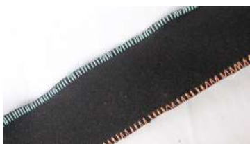
Figura 101 – Teste de pontos caseados para utilização no arnês.
