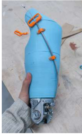
Figura 69 – Pintura, colagem e montagem do braço da prótese.
