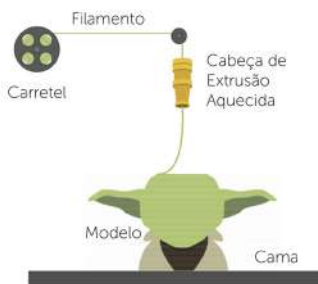
Figura 50 – Processo de modelo por fusão e deposição (FDM) (GUIA: A Tecnologia de Impressão 3D | by Brasília Fab Lab | Brasília Fab Lab | Medium, n.d.).
