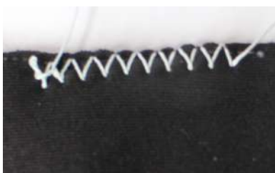
Figura 106 – Amostra de neoprene caseado com linha com maior espessura.
