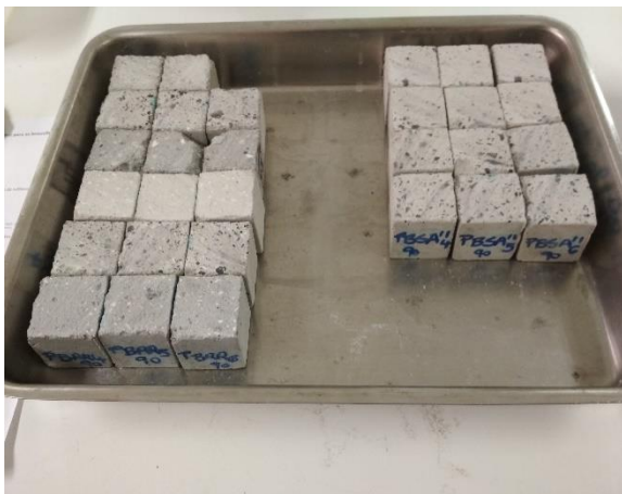
Figura 53 Amostras em cubos para ensaio à existência de sais
