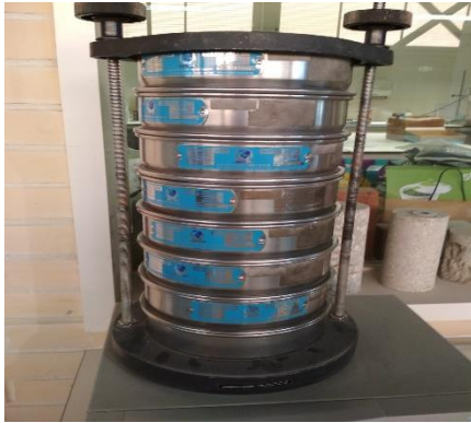
Figura 9 Equipamentos para análise da distribuição granulométrica
