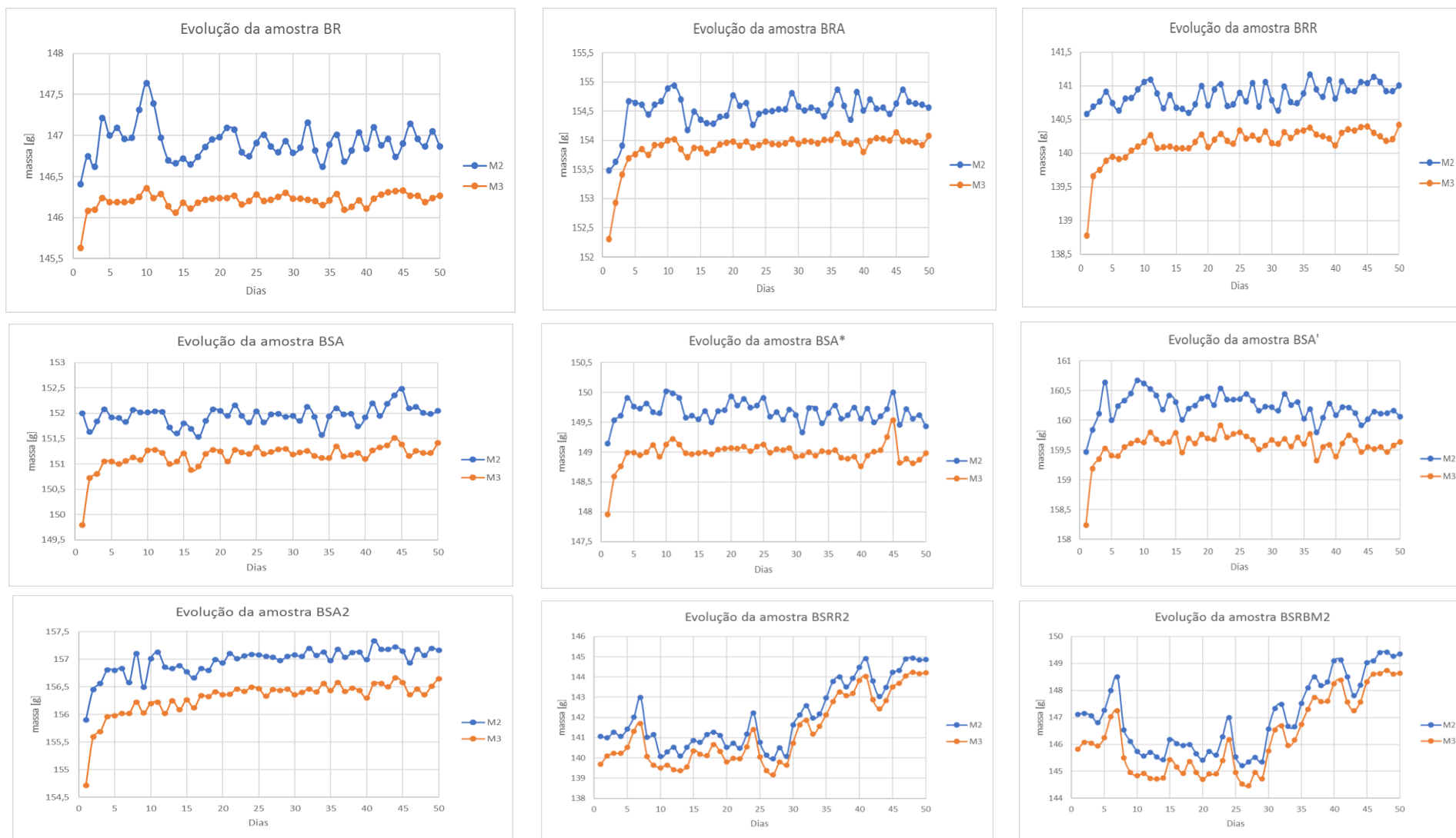
Figura 59 Evolução das amostras de betonilhas imersas em solução de sulfato de zinco
