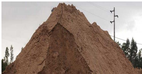
Figura 8 Agregados recuperados de granulometria fina (0-10mm) (RCD- Resíduos de Construção e Demolição SA, 2014)
