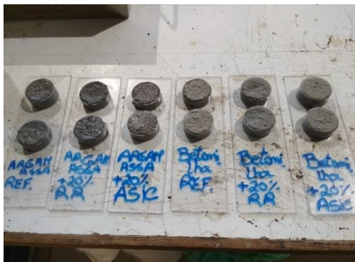
Figura 37 Amostras para o ensaio de condutibilidade térmica
