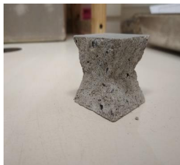
e) Amostra após ensaio de compressão
