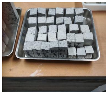
b) Amostras em câmara climática após os ensaios de flexão e compressão
