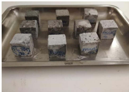
b) Amostras secas após imersão em sulfato de zinco (aparecimento de cor branca sobre algumas amostras)
