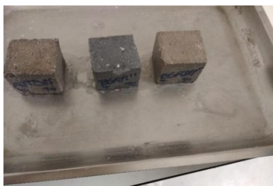
d) Argamassa com resíduo Britado Mesclado e betonilhas com resíduo Refratário e resíduo Britado Mesclado (ARBM, BSRR2, BSRBM2), amostras secas após imersão em sulfato de zinco
