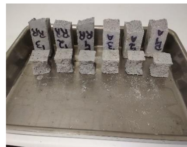
c) Amostras de argamassa de referência e com resíduo refratário após ensaios de flexão e de compressão
