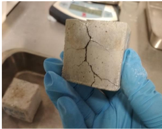
f) Betonilha com resíduo Britado Mesclado (BSRBM2), amostra seca a fissurar
