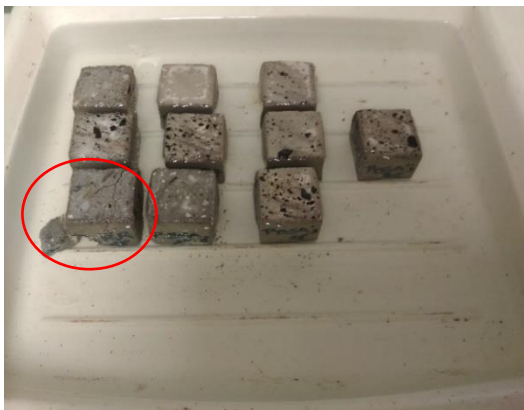
c) Argamassa com resíduo Refratário (AR) a deteriorar-se estando imersa em água destilada (círculo vermelho)
