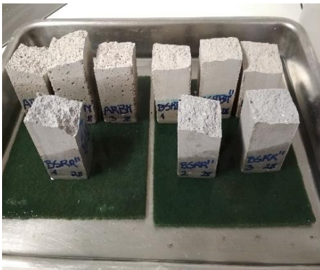
Figura 52 Amostras submetidas ao ensaio de capilaridade
