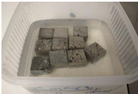
a) Amostras imersas em sulfato de zinco
