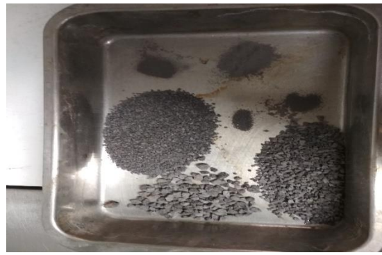
b) Resíduo ASIC após análise granulométrica
