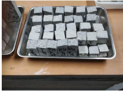
Figura 41 Amostras após a resistência à flexão
