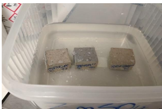
c) Argamassa com resíduo Britado Mesclado e betonilhas com resíduo Refratário e resíduo Britado Mesclado (ARBM, BSRR2, BSRBM2), amostras imersas em sulfato de zinco
