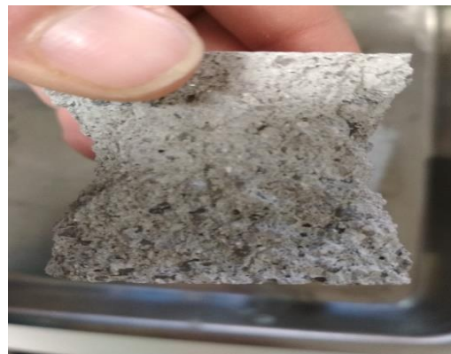
Figura 45 Amostra após a resistência à compressão
