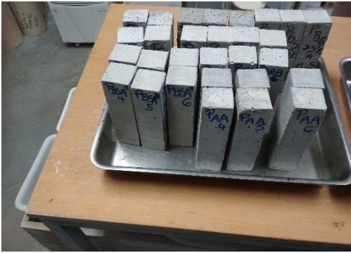
Figura 40 Amostras antes da resistência à flexão
