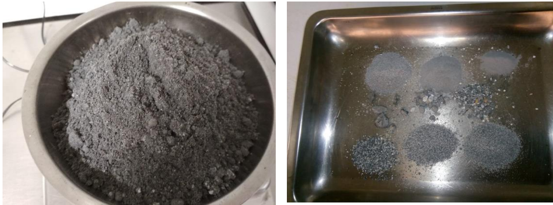
a) Resíduo refratário antes da análise granulométrica b) Resíduo refratário após análise granulométrica
