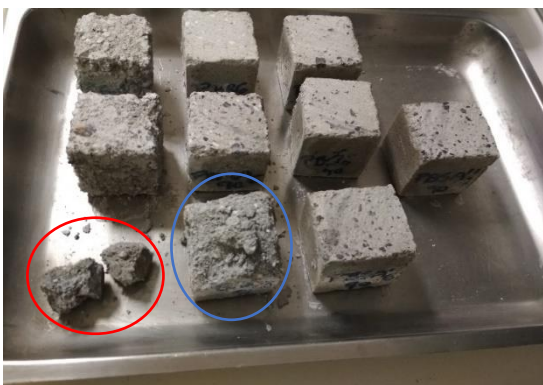
c) Argamassa com resíduo Refratário (AR) totalmente degradada por ter sido imersa em sulfato de sódio (amostra com círculo a vermelho)
