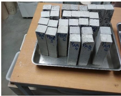
Figura 21 Amostras utilizadas na determinação da massa volúmica
