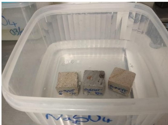
d) Argamassa com resíduo Britado Mesclado e betonilhas com resíduo Refratário e resíduo Britado Mesclado (ARBM, BSRR2, BSRBM2), amostras imersas em sulfato de sódio
