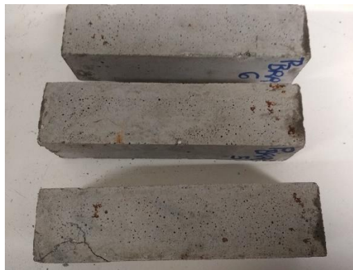
Figura 47 Betonilha BRR aos 90 dias
