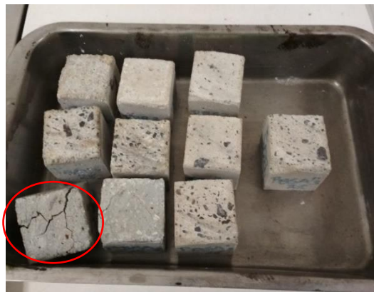
d) Argamassa com resíduo Refratário (AR) a fissurar, amostra seca após imersão em água destilada (círculo vermelho)
