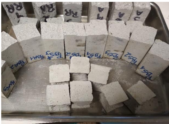
Figura 44 Amostras antes da resistência à compressão
