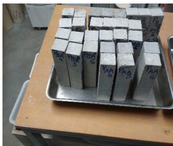
a) Amostras em câmara climática antes dos ensaios à flexão e à compressão
