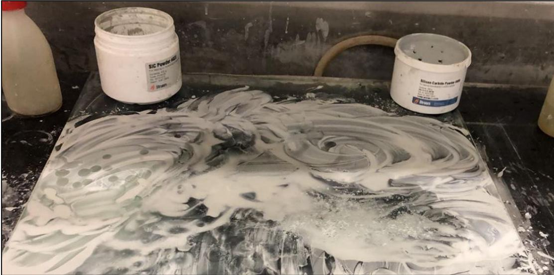
Figura V-3 - Procedimento de polimento para obtenção da espessura pretendida nas lâminas delgadas.
