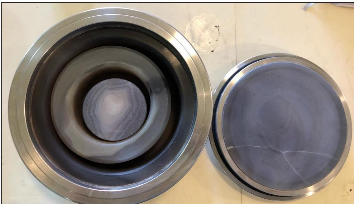
Figura V-6 - Moinho de anéis de ágata utilizado para pulverização das amostras para obtenção da granulometria inferior a 200 mesh.
