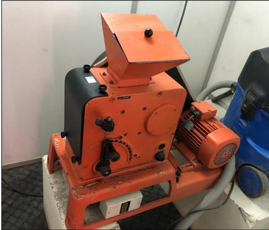
Figura V-5 - Fragmentador de maxilas de movimento composto utilizado no processo.
