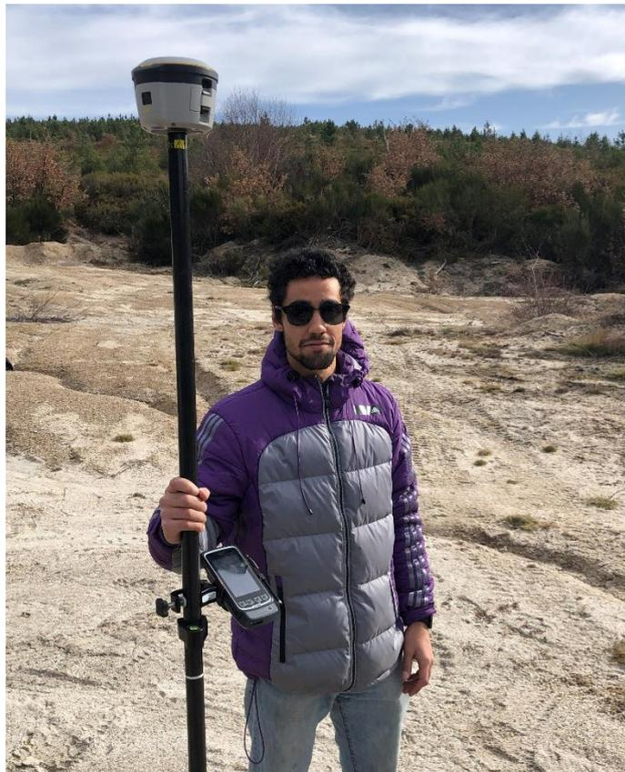
Figura IX-3 - Delimitação da área de escombreira com o GPS Trimble R2 GNSS Receiver
