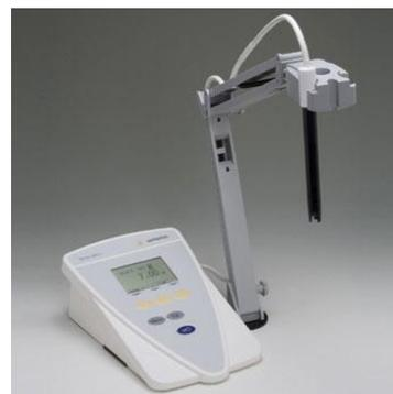
**Figura 6** – Representação de um medidor de pH de bancada Sartorius Docu-pH+ Meter
