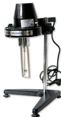
**Figura 9** – Representação do viscosímetro mecânico Brookfield Viscometer Model RVT
