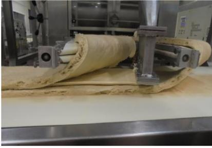
**Figura 2** – Fase 1 do processo de laminagem da massa: extrusão da massa e da margarina e disposição de uma camada de margarina entre duas camadas de massa.
