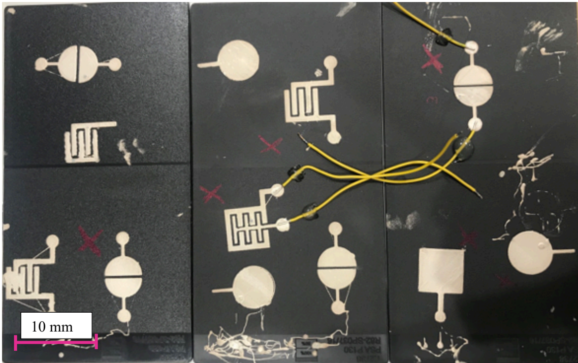
Figura 59: Impressões por Robocasting com tinta de prata com o 3º envelhecimento (5h a 60 °C, 15h a 70 °C, 2h a 80 °C e 1h a 85 °C).
