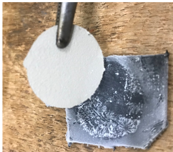
Figura 62: Sensor circular a cheio da 1ª série impresso com tinta de prata sem envelhecimento em PP.
