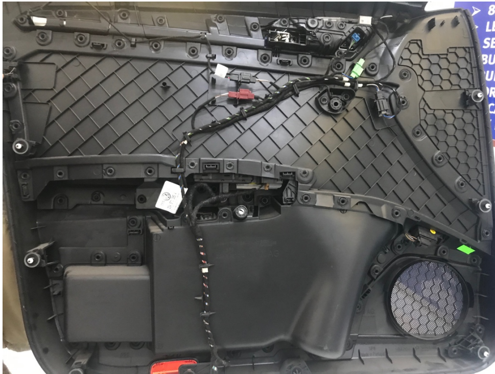
Figura 5: Parte interna de um painel de porta, que se apresenta com os componentes eletrónicos, revestidos pela cabelagem, que são integrados pela Simoldes Plásticos.
