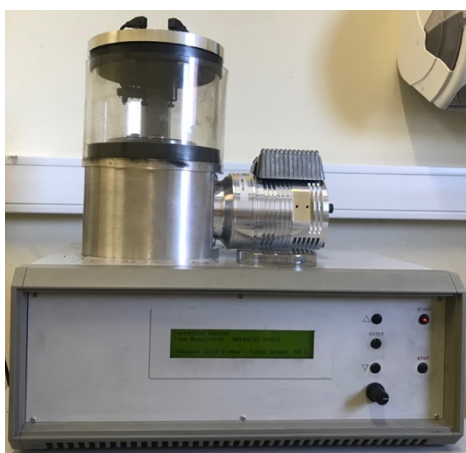
Figura 14: Equipamento EMITACH – K950 X para a deposição de uma camada fina de grafite para as amostras não condutoras (ABS e PP).
