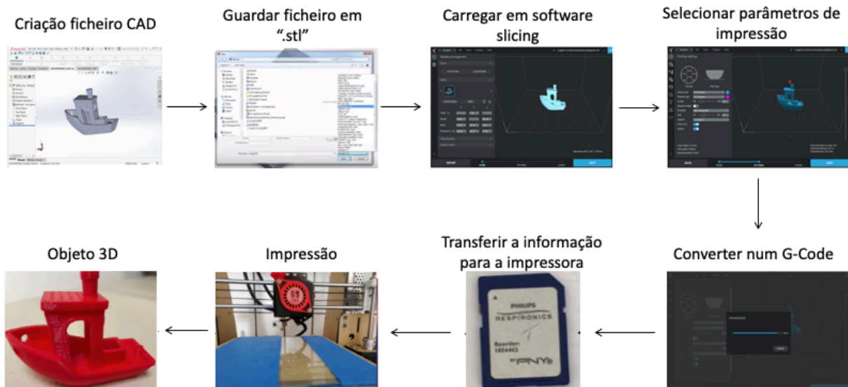
Figura 6: Esquema das etapas do processo de fabrico por Manufatura Aditiva.
