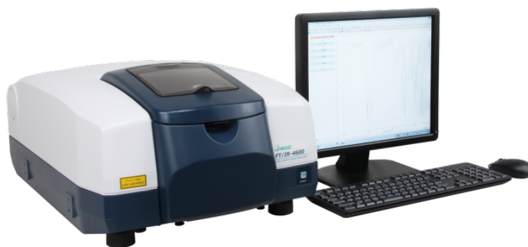
Figura 16: Equipamento Fourier-transform infrared spectroscopy 4700 Jasco presente no laboratório da Simoldes Plásticos.
