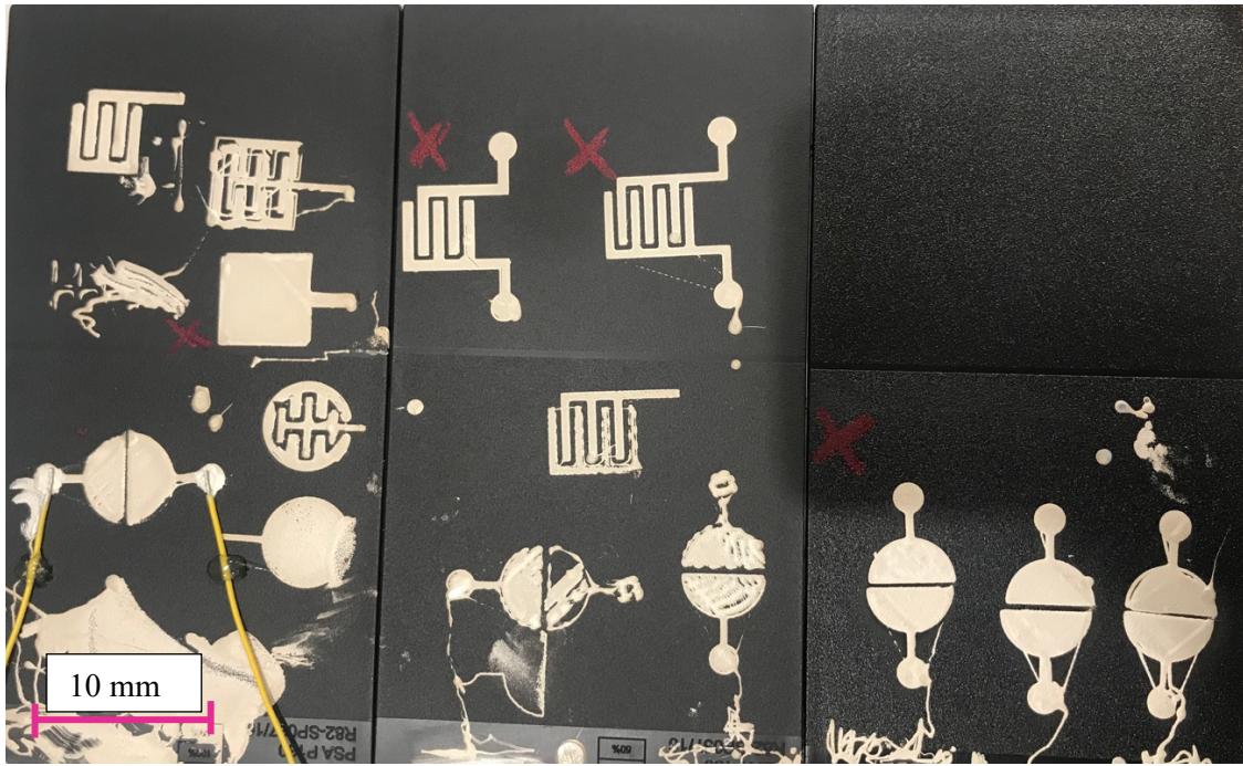
Figura 57: Impressões por Robocasting com tinta de prata com o 1º envelhecimento (20h a 40 °C e 2h a 50 °C).
