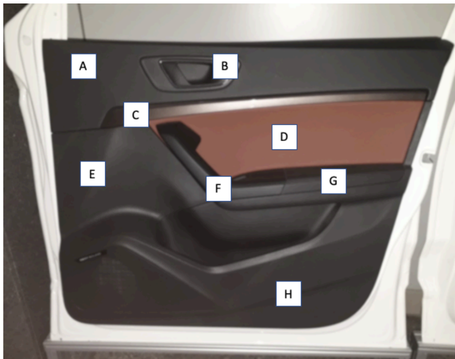
Figura 3: Constituição de um painel de porta exemplo (SEAT ATECA): A) cintura; B) abertura de porta, C) embelezador; D) medalhão; E) corpo do painel; F) pega da porta; G) apoia-braço e H) bolsa.
