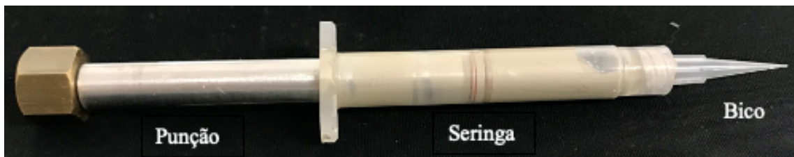
Figura 22: Robocasting 3D Inks, LLC, modelo EBRD-A32_0_0 e legenda dos seus eixos e principais componentes.
