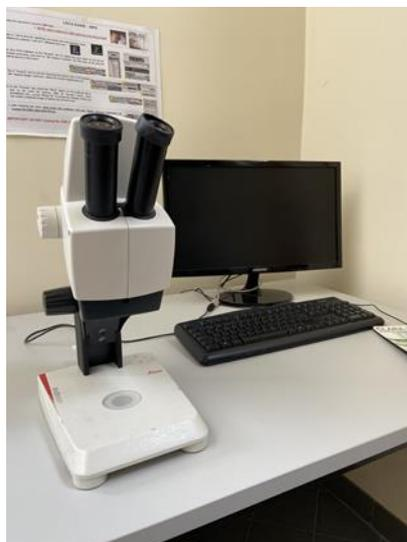
**Figura 18** – Microscópio ótico com câmara digital e com conexão ao computador - LUPA LEICA EZ4HD.
