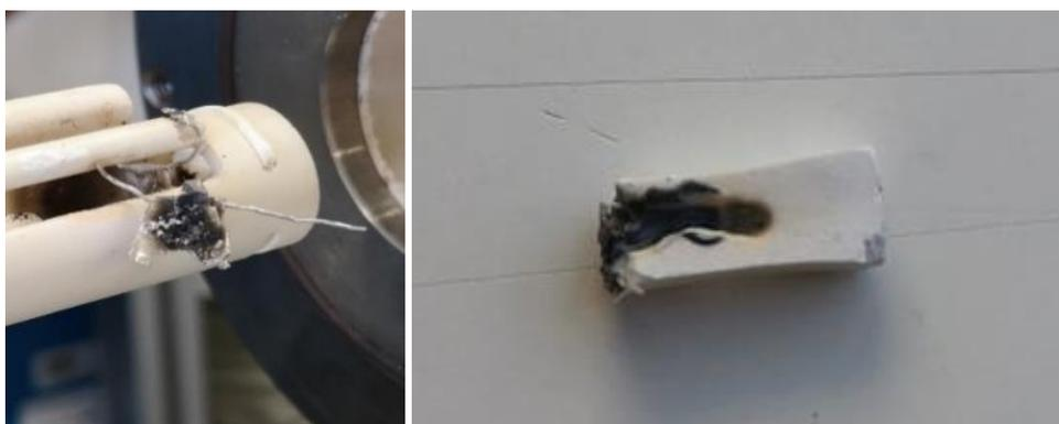
**Figura 49** - Aspeto final de um elétrodo de platina e da amostra com grafite grossa obtida com a aplicação de  $80\ \text{V/cm}$ .
