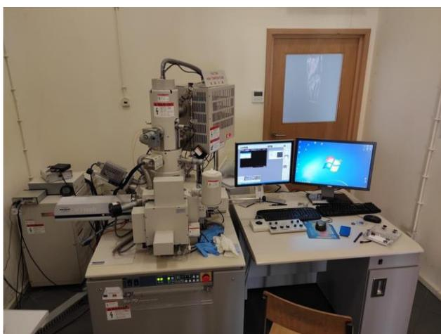
**Figura 15** - Microscópio Eletrónico de Varrimento (MEV) Hitachi SU-70.
