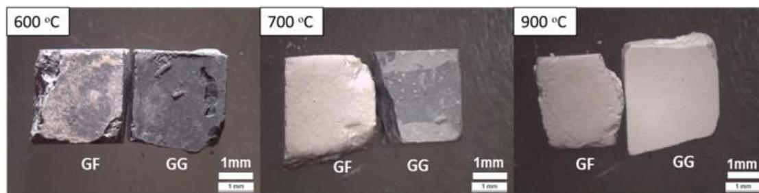
**Figura 43** – Comparação de cor entre compactos de misturas de alumina com grafite fina – GF e grafite grossa – GG, quando sujeitos a temperaturas de 600, 700 e 900 °C.
