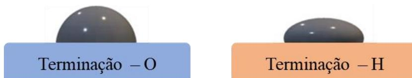
**Figura 11-** Esquema do ângulo de contato em superfícies BDD com terminações superficiais O- e H-, respectivamente da esquerda para a direita, adaptado de [6].
