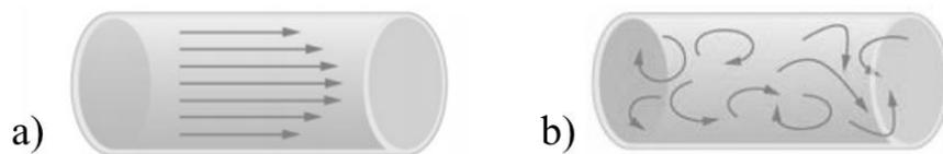
**Figura 5 - Tipos de regimes de um fluido: (a) regime laminar; (b) regime turbulento, adaptado de [41].**
