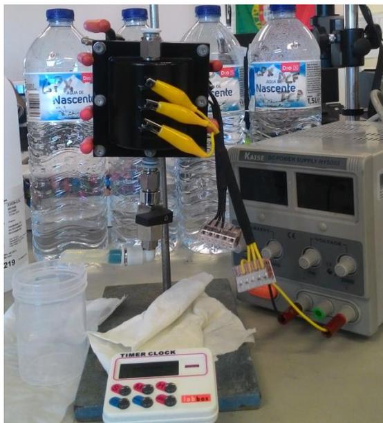
**Figura 16 - Montagem experimental para os ensaios experimentais de eletro-oxidação dos poluentes aquáticos em condições dinâmicas.**
