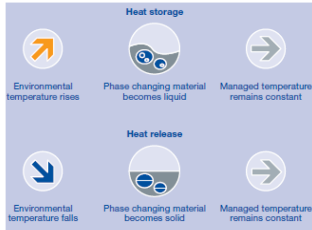
Figura 6 – O ciclo de um PCM Fonte: BASF The chemical company, 2006
