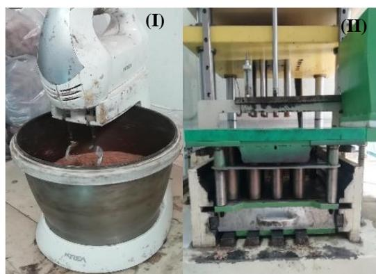
Figura 3.3 - Misturador (A) e moldadora piloto utilizados (B na produção de rolhas microaglomeradas).
