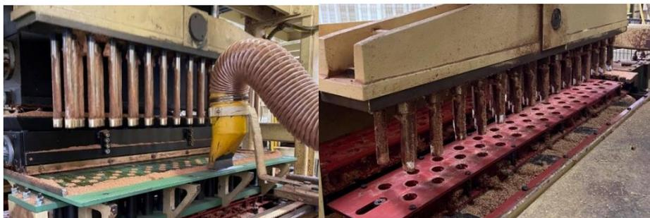
*Figura 2.8 - Moldadora utilizada na produção de rolhas microaglomeradas.*
