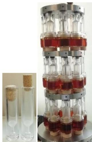
Figura 3.1 - Tubos de acrílico e Carrossel utilizado para os testes de fugas.
