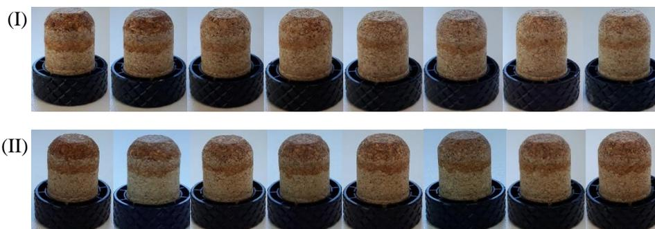
Figura 4.27 - Aspeto final das rolhas após o ensaio de envelhecimento (I) rolhas produzidas com a cola B1 (II) rolhas produzidas com a cola rTDI2.
