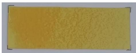
Figura 3.2 - Exemplo de um filme de cola, B1, usado para a caracterização.
