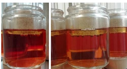
Figura 4.8 - Demonstração do nível 5 na escala de fugas usada para estes ensaios.
