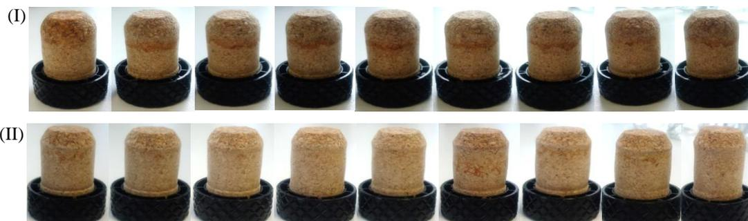
Figura 4.13 - Aspeto final das rolhas após o ensaio de envelhecimento (I) rolhas de referência (II) rolhas com diâmetro superior (19.7 mm).
