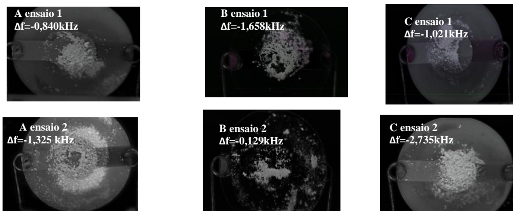
Figura 18 - Fotos dos revestimentos A (ensaio 1 e 2), B (ensaio 1 e 2), C (ensaio 1 e 2). Os cristais apresentam o respetivo decréscimo na frequência em serie ( \Delta F ).
