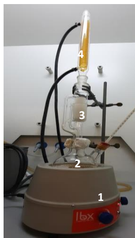
Figura 9 - Fotografia da montagem experimental para lavagem com Soxhlet; 1- manta de aquecimento; 2- balão com solvente extrator; 3- câmara de extração; 4- condensador.
