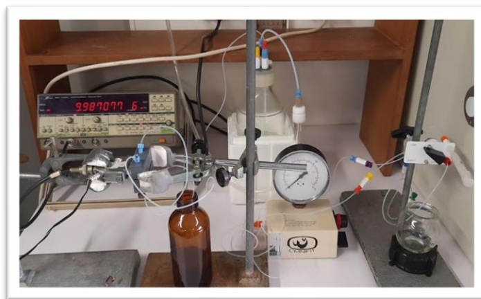
Figura 11 - Foto do arranjo experimental para o sistema de FIA com detecção por microbalanças de cristais piezoelétricos de quartzo.
