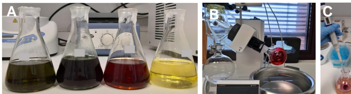
Figura 2: Representação do processo de preparação de extratos de plantas. A – Mistura de extrato de planta com etanol (EtOH) após centrifugação e filtração. B – Evaporação do etanol (EtOH) e obtenção do extrato bruto de planta. C – Adição de DMSO ao extrato bruto de planta.
