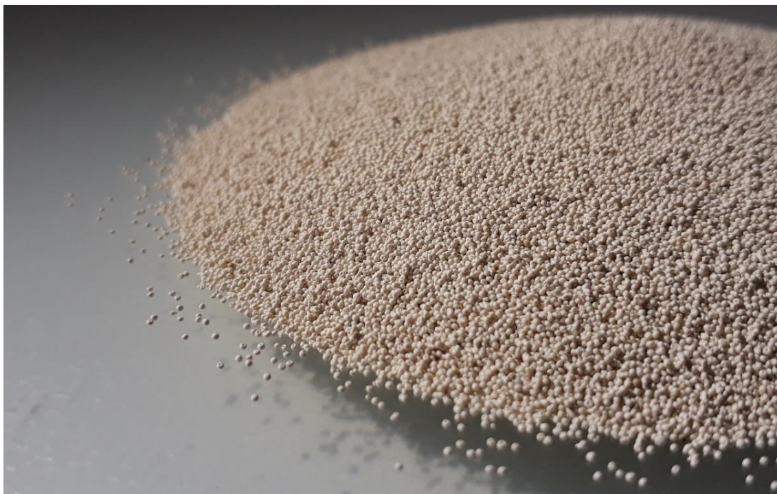
Figura 34. Parte do cone de espalhamento formado pela fração superior a 500\ \mu\text{m} da pasta P1.
