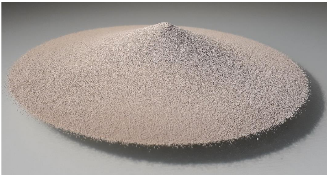
Figura 30. Exemplo de cone de espalhamento realizado com os granulados.
