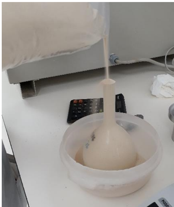
Figura 8. Balão com massa e volume conhecidos usado para a determinação da densidade aparente, DA . O balão tem volume de V = 500 ml.
