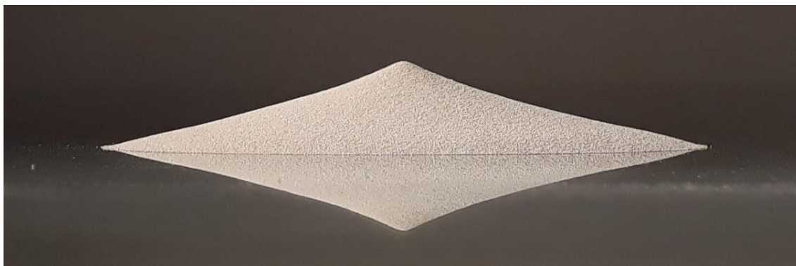
Figura 35. Vista de perfil do cone de espalhamento da fração inferior a 200\ \mu\text{m} da pasta P2.
