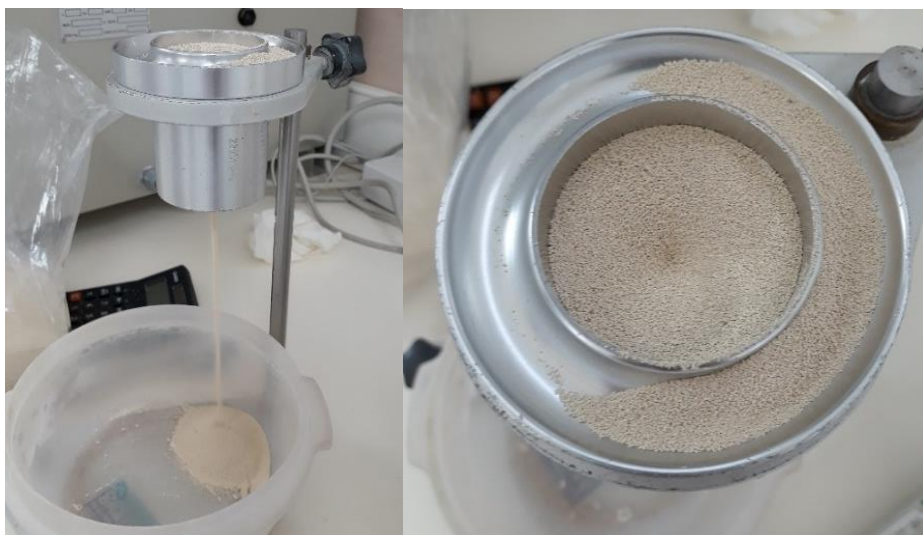
Figura 7. Ensaios de escoamento com taça Ford n.º 4: enche-se o recipiente com o granulado (à direita) e é medido o tempo de escoamento (à esquerda).
