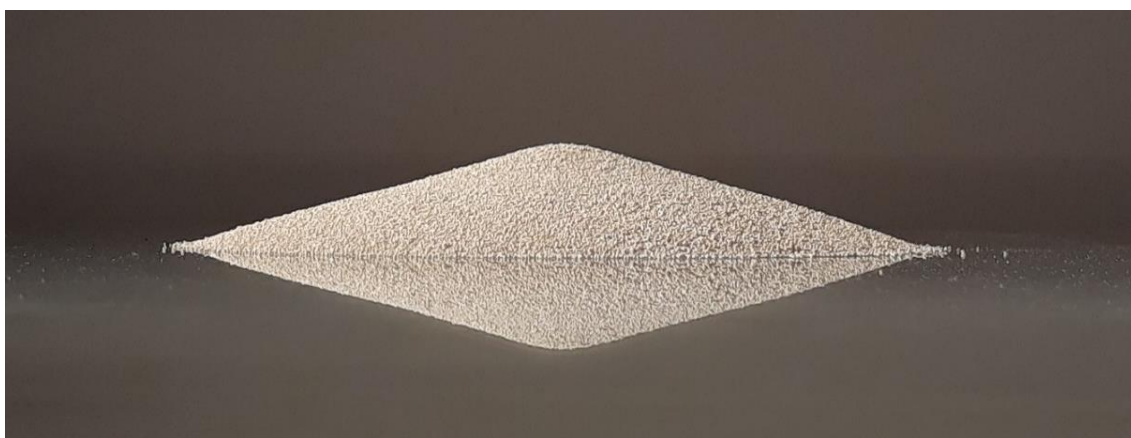
Figura 31. Fotografia do perfil do cone formado pelo granulado da pasta P1.
