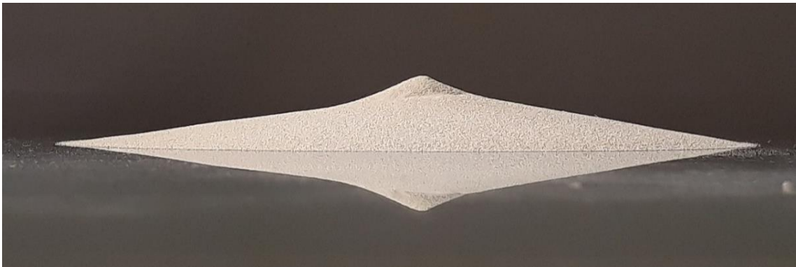
Figura 33. Vista de perfil do cone de espalhamento da fração inferior a 200 \mu\text{m} da pasta P1.
