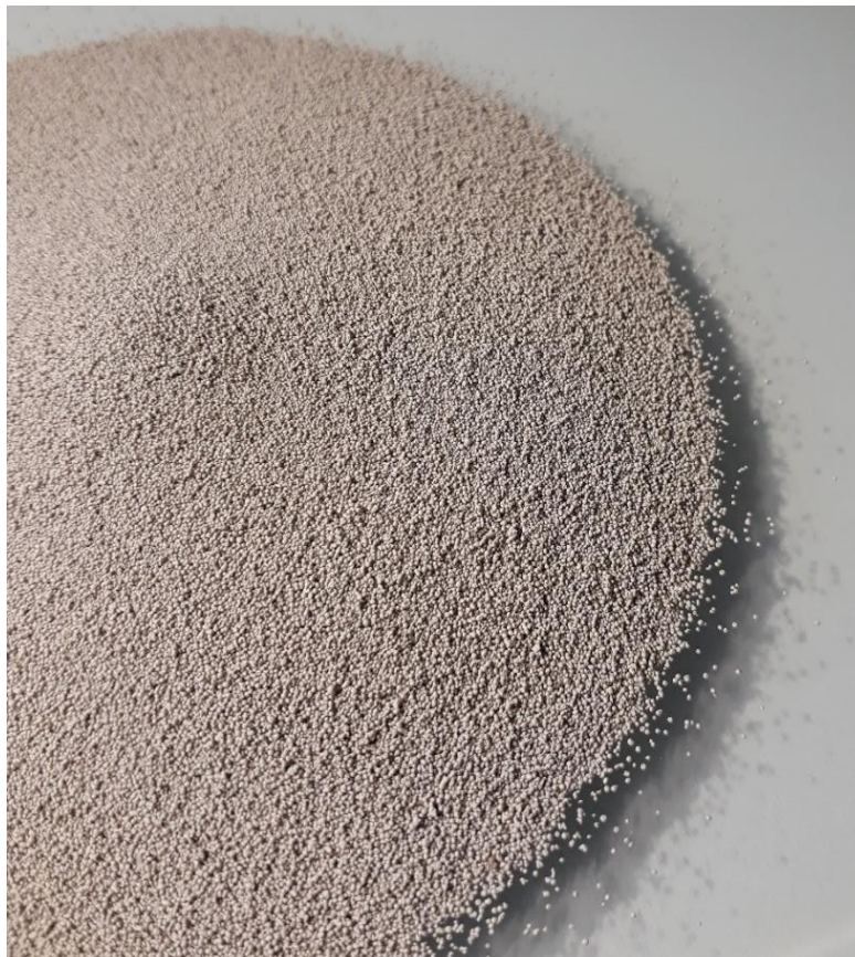
Figura 36. Espalhamento da fração superior da pasta G2: são poucos os agregados e grânulos de grandes dimensões que ultrapassam a linha da base onde a maioria permanece.
