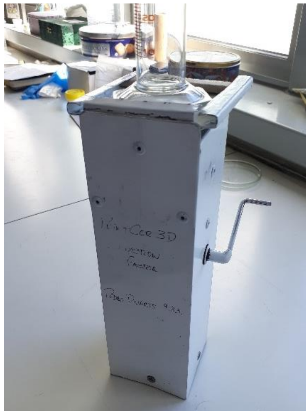
Figura 4. Composição usada nos ensaios para determinar a densidade tapping .
