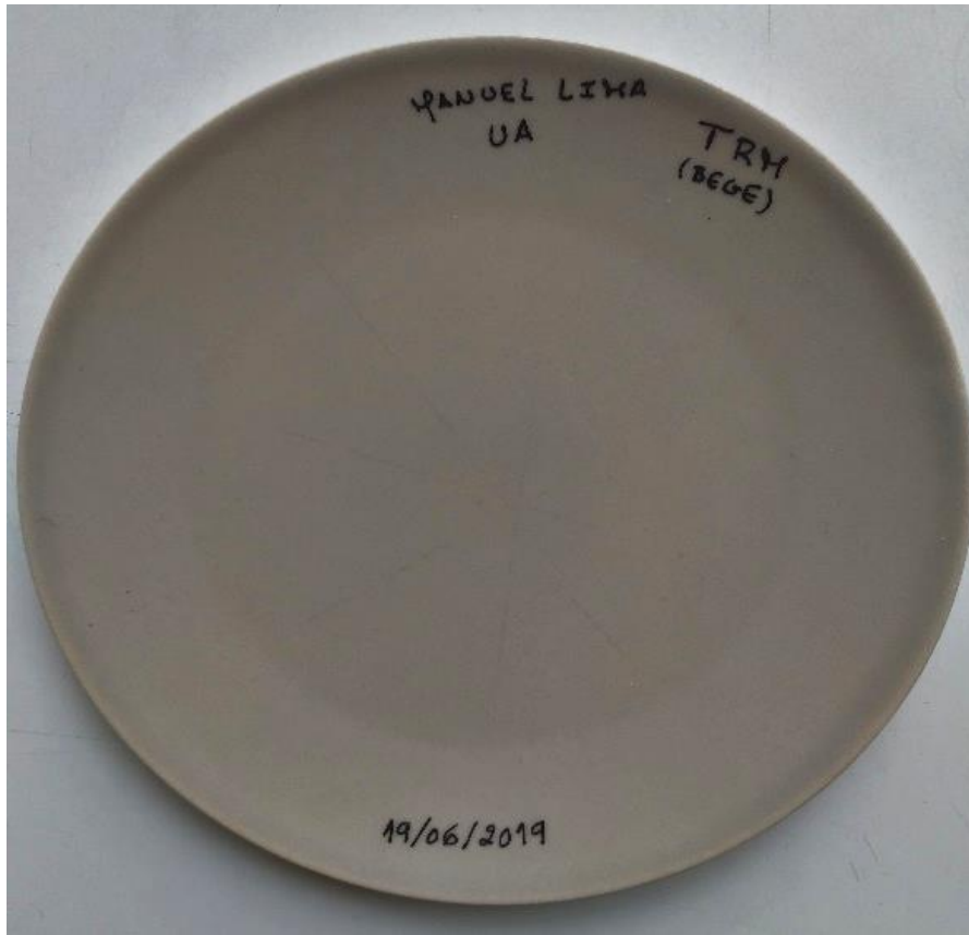
Figura 16 – Prato vidrado com VM2 submetido a ensaio industrial.
