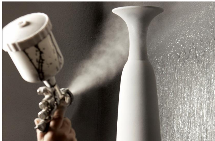
Figura 2 – Técnica de vidragem à pistola (manual). [12]
