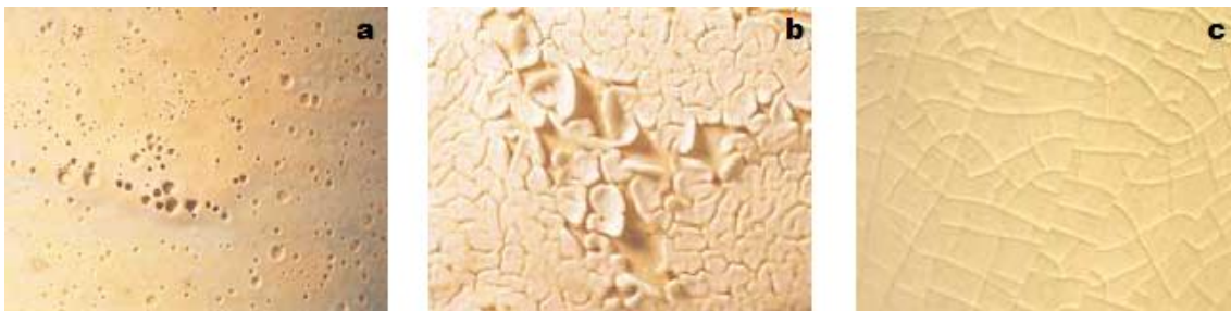
Figura 4 – Exemplos de defeitos comuns em vidrados cerâmicos. a – picado; b – enrolamento e c – fendas. [16] A ausência de um exemplo de martelado deve-se à dificuldade de identificação deste defeito através de imagens.
