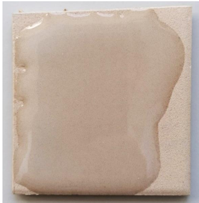
Figura 17 – Amostra do vidro transparente (VT) cozida a 1170 °C.
