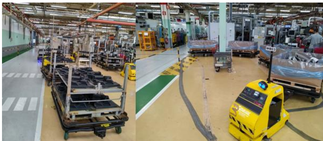
Figura 38 - Paragens mal programadas dos AGV's
