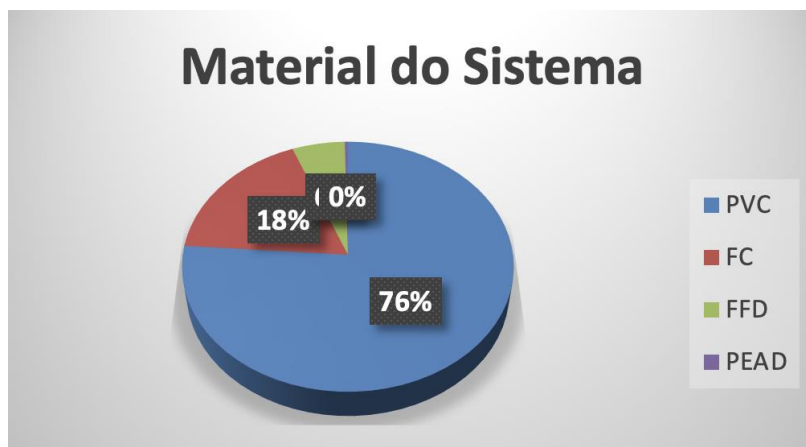
Figura 25. percentagem dos materiais das condutas no Município de Cantanhede(INOVA-EM-DS.A.,2013), adaptado de Civil & Martinho (2013)
