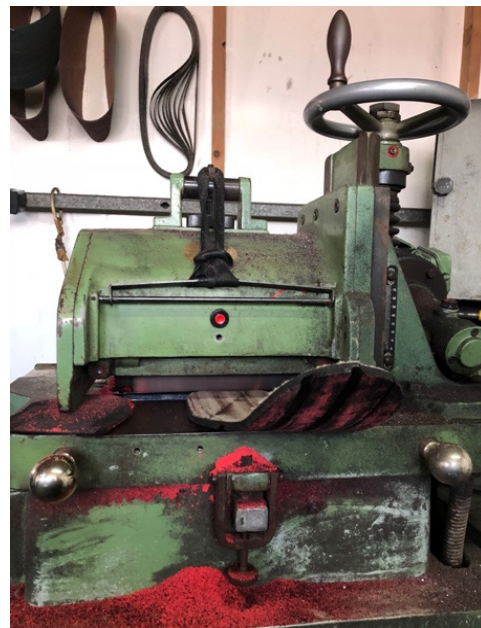
Fig. 438-439 Máquina de lixar sola de pneu, detalhe. Adquirida por António da Cunha, na década de 60, para a empresa Macaliba, atual Cualvo. Fonte: CDAB.
