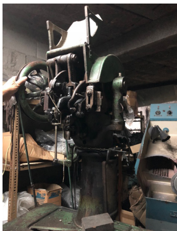
Fig. 455 Máquina de palmilhar a fio. Considerada como máquina da primeira geração, ou seja, a primeira que se seguiu à montagem manual. Adquirida por António da Cunha, na década de 50, para a empresa Macaliba, atual Cualvo. De acordo com Alberto da Cunha, num primeiro momento da construção mecânica de calçado foi usado o grampo, posteriormente, o fio. Fonte: CDAB.
