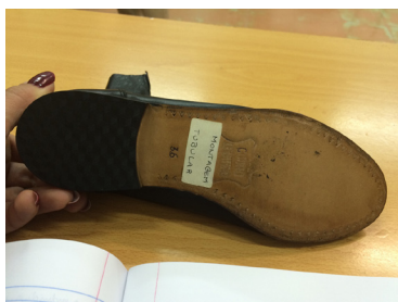
Fig. 123 Montagem Tubular de sapato da Academia de Design e Calçado. Fonte: CDAB.
