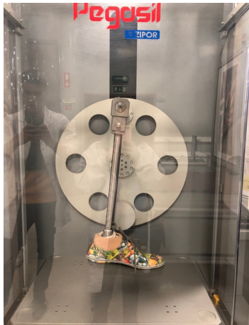
Fig. 341 Simulador de marcha para medição de força e pressão, para realização de testes no CTCP. Fonte: CDAB.
