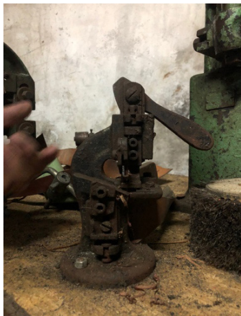
Fig. 446 Máquina de abrir o rasgo na vira. Considerada como máquina da primeira geração, ou seja, a primeira que se seguiu à montagem manual. Adquirida por António da Cunha, na década de 50, para a empresa Macaliba, atual Cualvo. Fonte: CDAB.
