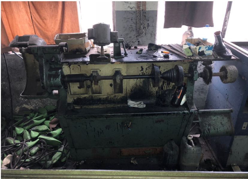
Fig. 466 Máquina dos sete instrumentos, adquirida por Francisco Rodrigues na década de 60 para a empresa A Portuguesa. A Alemanha foi o primeiro país a construir a máquina, sendo que Itália se inspirou nela e por sua vez, Portugal inspirou-se na versão italiana da mesma. A máquina efetuava as seguintes operações: lixava, fresava e escova, proporcionando vários acabamentos no calçado. Fonte: CDAB.
