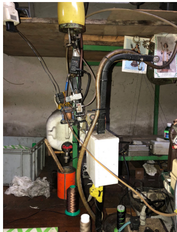
Fig. 468-469 Máquina de cravar a sola ao corte, alterada por Silvério Félix. Fonte: CDAB.
