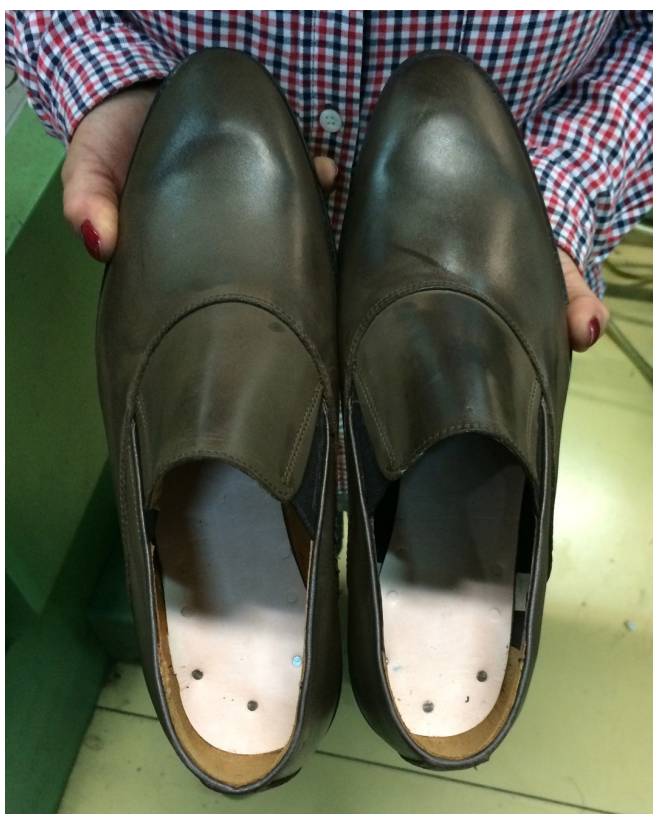
Fig. 118 (em cima) Par de sapatos montado em montagem plana no Curso de Montagem, 2015, realizado na Academia de Design e Calçado. Fonte: CDAB.
