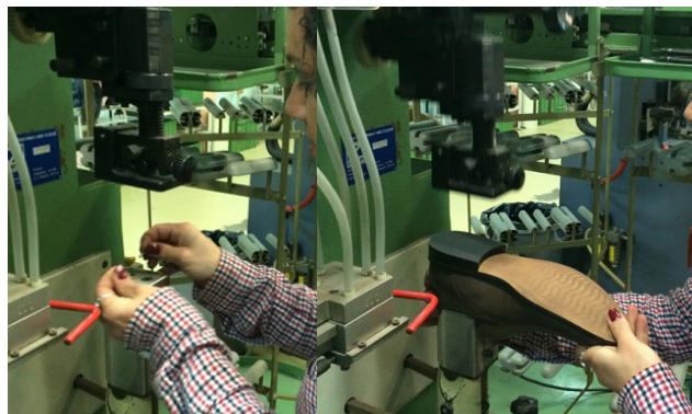
Fig. 117 Pregar o salto na sola do sapato com recurso à máquina de pregar. Fonte: CDAB.
