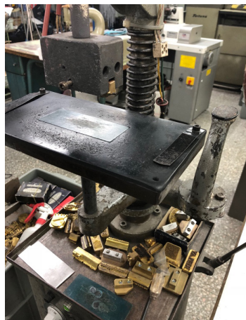
Fig. 529 Máquina de timbrar a quente. Adquirida por Alberto da Cunha atualmente usada na empresa Tulipa Negra, década de 70. Fonte: CDAB.
