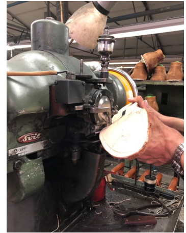
Fig. 461-462 Máquina de pontear para montagem em sistema Pratik. Adquirida por António da Cunha, na década de 60, para a empresa Macaliba, atual Cualvo. De acordo com Alberto da Cunha, todos os fabricantes detinham essa máquina, que além de pontear, daria para colocar a vira. Fonte: CDAB.
