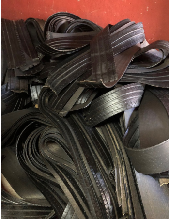
Fig. 227 Pneu utilizado atualmente para o desenvolvimento de solas. Fonte: CDAB.
