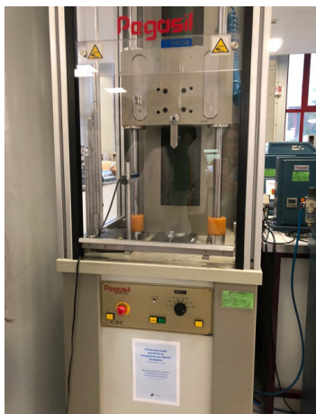
Fig. 344 Sistema para medir a resistência ao esmagamento por impacto da biqueira, para realização de testes no CTCP. Fonte: CDAB.
