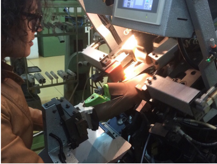
Fig. 110 Centrar a biqueira do sapato na máquina de centrar. Fonte: CDAB.
