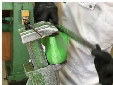
Fig. 93 Desenvolvimento de 'fôrma'. Empresa A Industrial dos Carvalhinhos. Fonte: CDAB.
