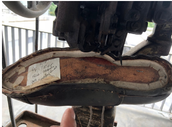
Fig. 457-458 Modelo de calçado palmilhado a fio. Levaria cortiça para o enchimento na palmilha e enfranques, sendo posteriormente colocada a sola, na qual se abriam frisos para a costura. Reconstrução atual do processo de montagem 'Goodyear' na década de 60. Fonte: CDAB.
