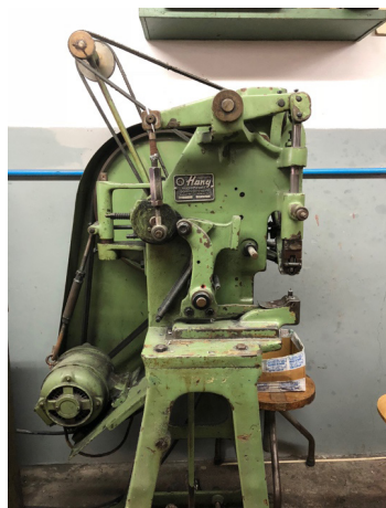
Fig. 528 Máquina de aplicar ilhós. Adquirida por António da Cunha para a empresa Macaliba, atual Cualvo, entre as décadas de 60 e 70. Fonte: CDAB.
