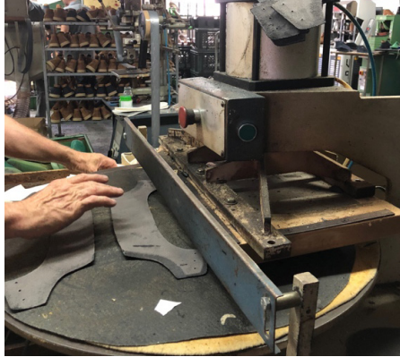
Fig. 548 Máquina de colar testeiras, contrafortes ou panos. Terá sido a primeira máquina giratória que surgiu. Adquirida por António da Cunha para a empresa Macaliba, atual Cualvo, década de 80. Fonte: CDAB.
