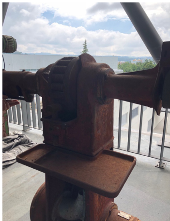
Fig. 522 Máquina de repuxar e rebater para aperfeiçoar as laterais. Adquirida em leilão e doada por Alberto da Cunha à Escola Secundária de Felgueiras, enquadrada entre as décadas de 60 e 70. Fonte: CDAB.
