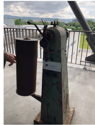
Fig. 534 Máquina de aplicar viras. Adquirida em leilão e doada por Alberto da Cunha à Escola Secundária de Felgueiras, enquadrada na década de 70. Fonte: CDAB.
