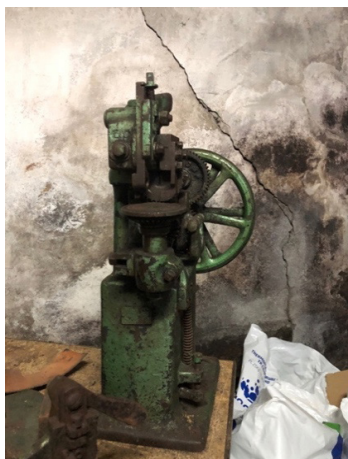
Fig. 449-450 Máquina de abrir o refendido na palmita em celeiro. Considerada como máquina da primeira geração, ou seja, a primeira que se seguiu à montagem manual. Adquirida por António da Cunha, na década de 50, para a empresa Macaliba, atual Cualvo. Fonte: CDAB.
