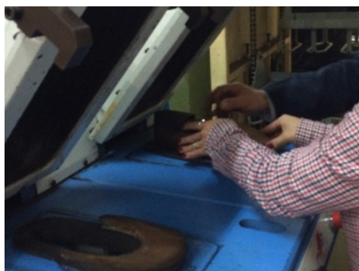
Fig. 115 Colocação do sapato na máquina de prensar. Fonte: CDAB.
