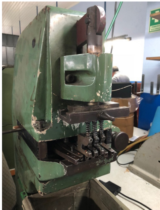
Fig. 535 Máquina de vazar, sendo que permite fazer cinco furos de cada vez. Adquirida por Alberto da Cunha, atualmente usada na empresa Tulipa Negra, década de 70. Trata-se de uma máquina portuguesa, da marca Lirel. Fonte: CDAB.
