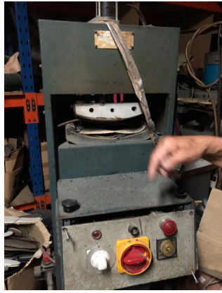
Fig. 531 Máquina de colar testeiras, uma a uma. Adquirida por António da Cunha para a empresa Macaliba, atual Cualvo, década de 70. Fonte: CDAB.
