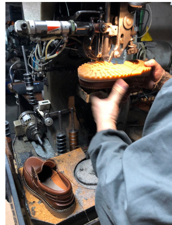
Fig. 468-469 Máquina de cravar a sola ao corte, alterada por Silvério Félix. Fonte: CDAB.
