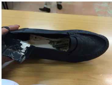
Fig. 122 Montagem Tubular de sapato da Academia de Design e Calçado. Fonte: CDAB.
