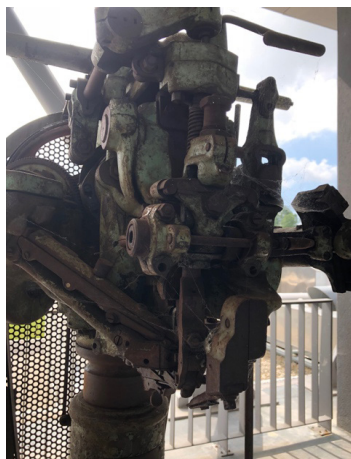
Fig. 453-454 Máquina de palmitar a grampo. Considerada como máquina da primeira geração, ou seja, a primeira que se seguiu à montagem manual. Permitiu obter custos de produção menores comparativamente ao palmitado a fio. Adquirida em leilão e doada por Alberto da Cunha à Escola Secundária de Felgueiras, enquadrada na década de 60. Fonte: CDAB.
