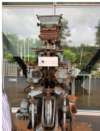
Fig. 464 Máquina de pregar à semilha. Adquirida em leilão e doada por Alberto da Cunha à Escola Secundária de Felgueiras, enquadrada na década de 60. Fonte: CDAB.
