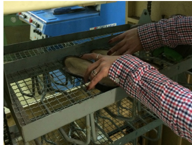
Fig. 113 Aplicação da cola na sola e secagem na torre de secagem. Fonte: CDAB.
