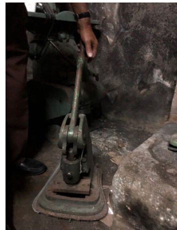
Fig. 451 Máquina de timbrar florões no corte. Considerada como máquina da primeira geração, ou seja, a primeira que se seguiu à montagem manual. Adquirida por António da Cunha, na década de 50, para a empresa Macaliba, atual Cualvo. Fonte: CDAB.
