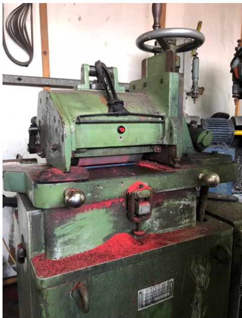
Fig. 438-439 Máquina de lixar sola de pneu, detalhe. Adquirida por António da Cunha, na década de 60, para a empresa Macaliba, atual Cualvo. Fonte: CDAB.
