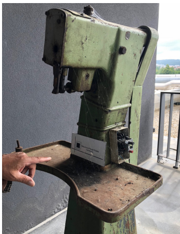
Fig. 526 Camborea para montar as laterais do calçado. Adquirida em leilão e doada por Alberto da Cunha à Escola Secundária de Felgueiras, enquadrada na década de 70. Fonte: CDAB.
