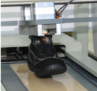
Fig. 46 Método de ensaio de determinação da resistência ao escorregamento do calçado. Fonte: CTCP, 2012a, p. 13.
