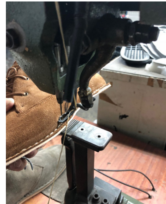
Fig. 536-537 Máquina de coser 'Pratik'; demonstração da costura do corte à sola. Adquirida por António da Cunha para a empresa Macaliba, atual Cualvo, em uso, década de 70, adaptada posteriormente. Fonte: CDAB.
