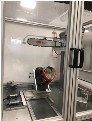
Fig. 343 Avaliação de calçado de segurança com resistência ao corte por motosserra, para realização de testes no CTCP. Fonte: CDAB.
