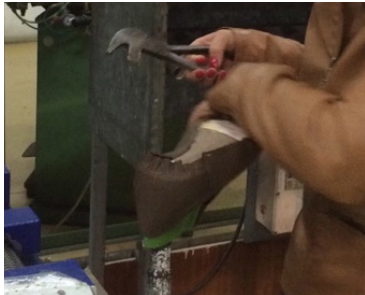
Fig. 112 Fechar a calcanheira do sapato com recurso a turquesa e martelo. Fonte: CDAB.
