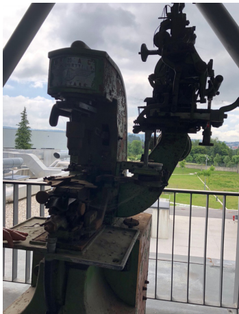
Fig. 463 Máquina de agrafar tacões. Adquirida em leilão e doada por Alberto da Cunha à Escola Secundária de Felgueiras, enquadrada na década de 60. Fonte: CDAB
