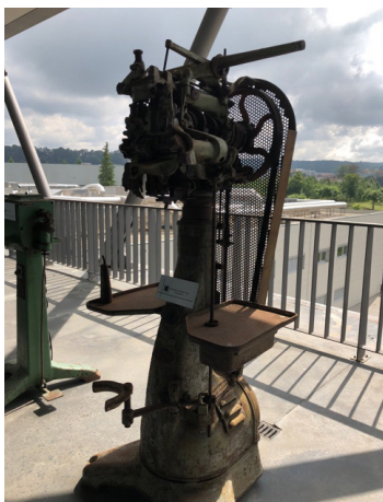
Fig. 453-454 Máquina de palmitar a grampo. Considerada como máquina da primeira geração, ou seja, a primeira que se seguiu à montagem manual. Permitiu obter custos de produção menores comparativamente ao palmitado a fio. Adquirida em leilão e doada por Alberto da Cunha à Escola Secundária de Felgueiras, enquadrada na década de 60. Fonte: CDAB.
