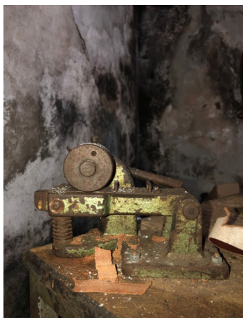
Fig. 447-448 Máquina de igualizar viras. Considerada como máquina da primeira geração, ou seja, a primeira que se seguiu à montagem manual. Adquirida por António da Cunha, entre as décadas de 50 e 60, para a empresa Macaliba, atual Cualvo. Fonte: CDAB.
