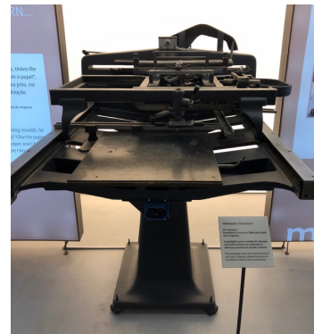
Fig. 19 Pantógrafo para escalonamento de moldes de calçado exposto no MDC, proveniente da Fábrica de Calçado Dura, Felgueiras. Fonte: CDAB.
