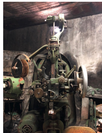
Fig. 452 Máquina de palmitar a grampo. Considerada como máquina da primeira geração, ou seja, a primeira que se seguiu à montagem manual. Exigia que as 'fôrmas' fossem chapeadas para ser possível vergar o grampo. Adquirida por António da Cunha, na década de 50, para a empresa Macaliba, atual Cualvo. De acordo com Alberto da Cunha, a origem da máquina é datada da década de 40. Fonte: CDAB.
