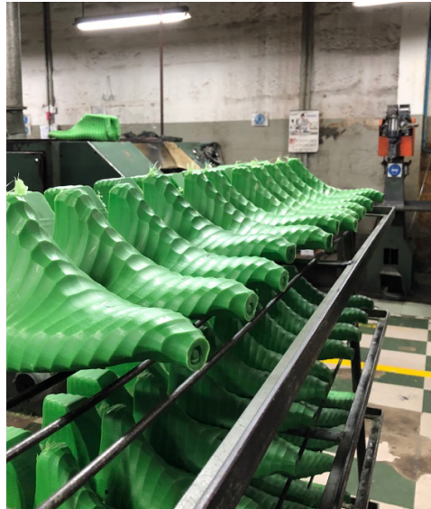
Fig. 98 Processo de produção de 'fôrmas'. Empresa A Industrial dos Carvalhinhos. Fonte: CDAB.
