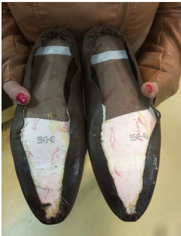
Fig. 111 Fechar as laterais do corte do sapato e da palmilha, com recurso a turquesa e martelo. Fonte: CDAB.
