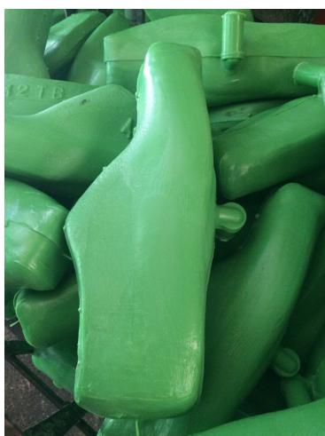
Fig. 96 'Processo de produção de 'fôrmas': primeira fase. Empresa A Industrial dos Carvalhinhos. Fonte: CDAB.
