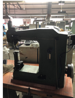
Fig. 536-537 Máquina de coser 'Pratik'; demonstração da costura do corte à sola. Adquirida por António da Cunha para a empresa Macaliba, atual Cualvo, em uso, década de 70, adaptada posteriormente. Fonte: CDAB.
