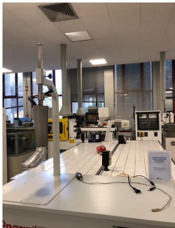
Fig. 342 Pé térmico com sudação e aquecimento parametrizáveis para avaliação do conforto térmico, para realização de testes no CTCP. Fonte: CDAB.
