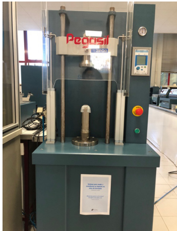
Fig. 345 Sistema para medir a resistência ao impacto na zona do tornozelo, para realização de testes no CTCP. Fonte: CDAB.
