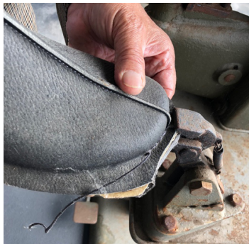
Fig. 444-445 Máquina de puxar o corte, demonstração. Considerada como máquina da primeira geração, ou seja, a primeira que se seguiu à montagem manual. Adquirida por António da Cunha, na década de 50, para a empresa Macaliba, atual Cualvo. Fonte: CDAB.
