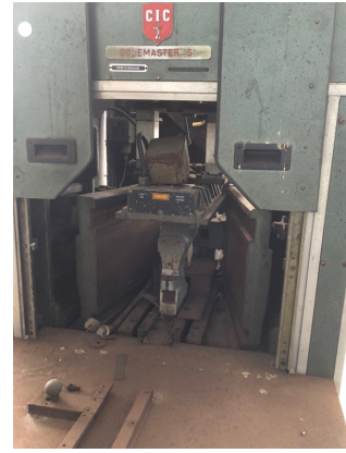
Fig. 532 Máquina de injetar que permitia fazer apenas um par de cada vez. Adquirida em leilão e doada por Alberto da Cunha à Escola Secundária de Felgueiras, enquadrada na década de 70. Fonte: CDAB.
