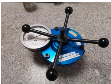
FIGURA 11 - DINAMÓMETRO USADO PARA OS ENSAIOS DE ADERÊNCIA POR TRAÇÃO PERPENDICULAR
