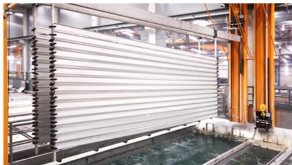
FIGURA 6 - ANODIZAÇÃO DE ALUMÍNIO OU LIGAS DE ALUMÍNIO, ADAPTADO DE [35].
