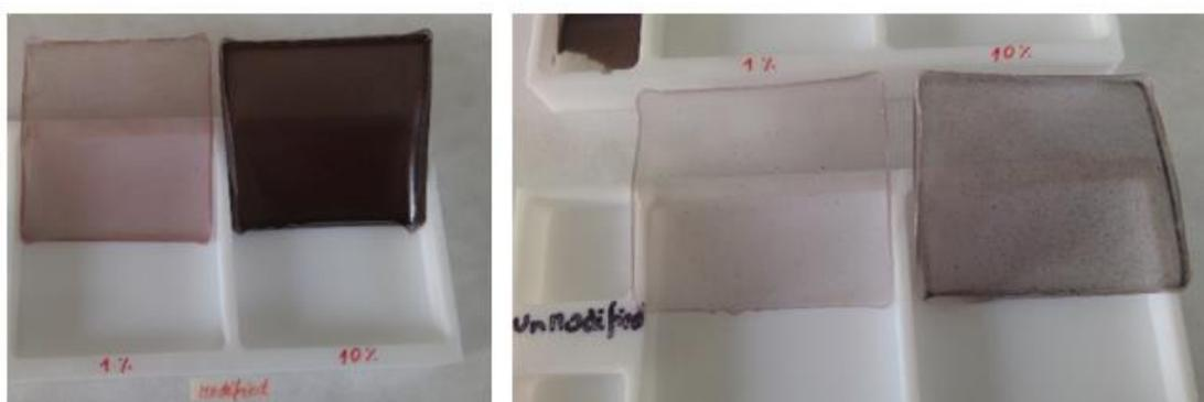
Figura I.19 – Compósitos de partículas de  $\text{LiFe}_2\text{O}_8$  modificadas e não modificadas dispersas em SIS, de concentração  $\%(m/m)$  de 1 e 10 %.
