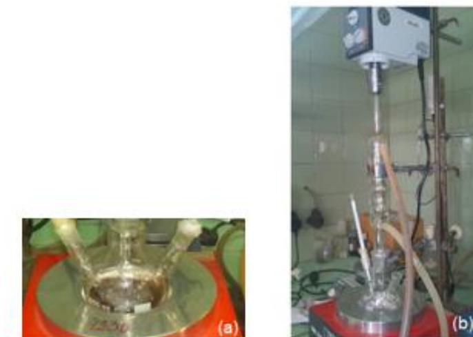
Figura I.16 – Processo de funcionalização da superfície das partículas: (a) preparação das partículas com tolueno e (b) adição de 3-aminopropiltriétoxisilano e refluxo da mistura por 8 h a 110 °C.
