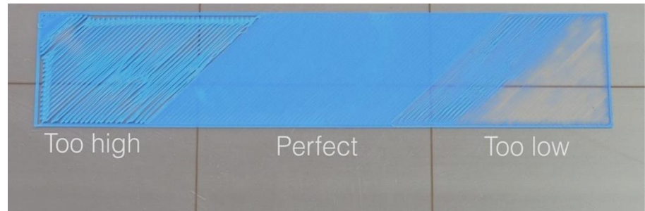
Figura 30 - Primeira camada – nivelamento – (Cults3d (1), n.d.)
