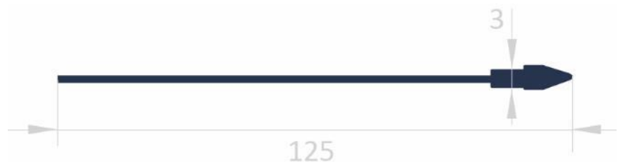
Figura 73 - Dimensões, em mm, da recarga para esferográfica
