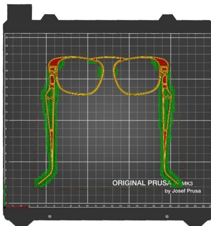
Figura 127 -Planificação de um par de óculos de sol na plataforma elevatória no software slicer – PrusaSlicer
