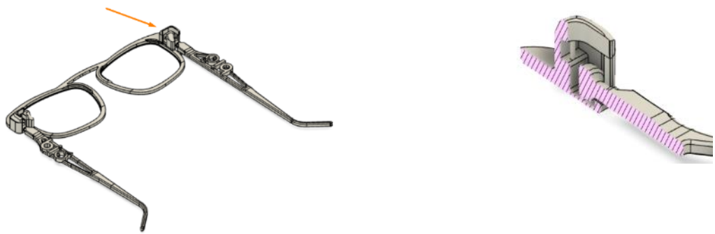
Figura 139 - Zona do encaixe que não leva suportes para suportar paredes na horizontal
