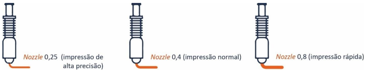
Figura 13 - Representação da saída do filamento com a dimensão do diâmetro do nozzle (figura alterado pelo autor) - (ULTIMAKER (1), n.d., p.14)
