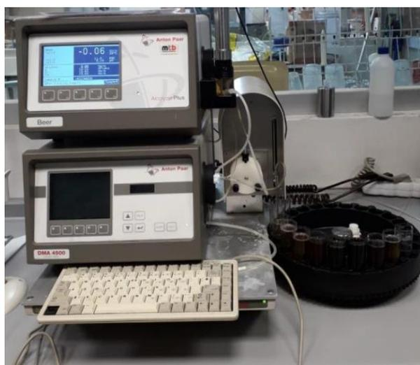
Figura 24 - Alkolyzer Plus Beer Analysis System da Anton Paar, presente no laboratório central nas instalações do Super Bock Group.
