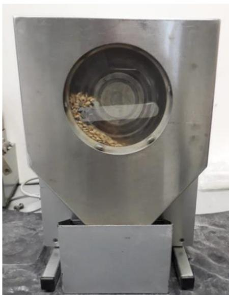
Figura 22 – Friabilómetro presente no laboratório central nas instalações do Super Bock Group.
