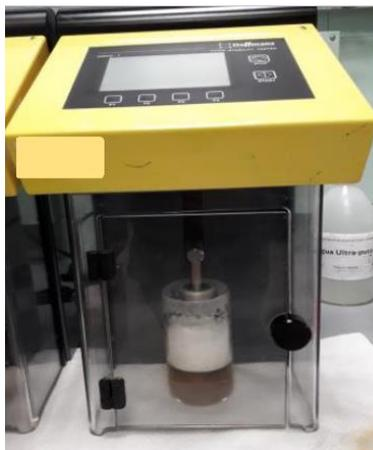
Figura 29 - Aparelho utilizado para a medição da estabilidade de espuma segundo o método NIBEM, presente no laboratório central das instalações do Super Bock Group.
