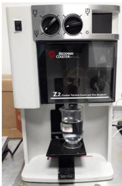
Figura 27 - Equipamento utilizado para contagem de células de levedura, presente no laboratório central das instalações do Super Bock Group.
