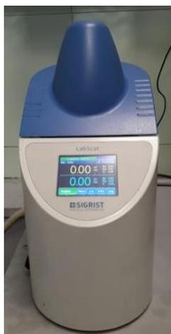
Figura 28- Equipamento utilizado para a leitura da turvação presente no laboratório central das instalações do Super Bock Group.
