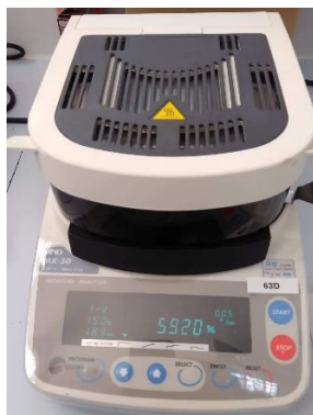
Figura 8. Ilustração dos parâmetros apresentados após finalização da análise como o tempo total da análise e o resultado da humidade.
