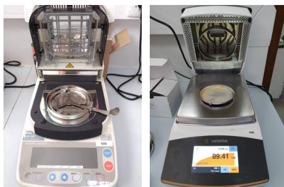
Figura 5. Métodos A (à esquerda) e B (à direita) de determinação da humidade por radiação infravermelha
