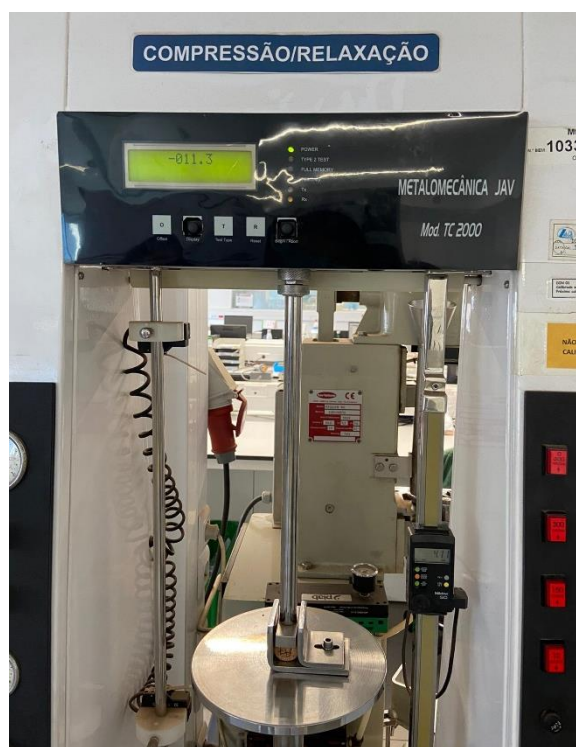
Figura 14 - Equipamento utilizado nos ensaios de Compressão/Relaxação.
