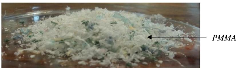
**Figura 15.** Resíduos de vidro acrílico à temperatura ambiente.
