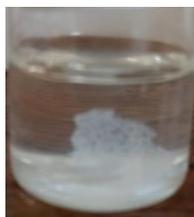
**Figura 17.** Resultado da dissolução de *PMMA* residual em *PEG 400* usando o micro-ondas.
