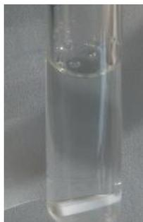
**Figura 16.** Resultado da dissolução de *PMMA* comercial em *PEG 400* usando o micro-ondas.
