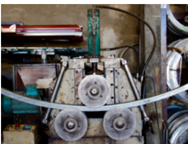
fig. 57: Dobragem de uma chapa.
