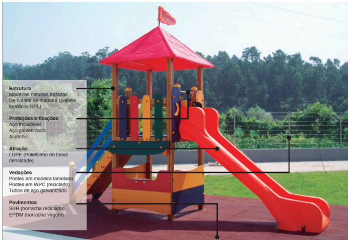
fig. 31: Tipologia de um parque exterior em Portugal e os materiais utilizados. fonte: Composição própria.
