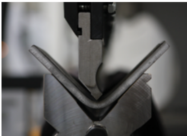
fig. 56: Quinagem de uma chapa.
