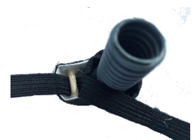
Figura 187 - Maquete: detalhes do sistema de tensionamento com copo
