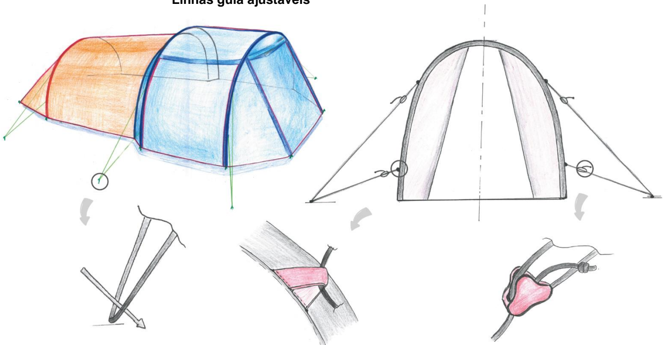
Figura 198 - Desenhos do sistema de linhas guia ajustáveis
