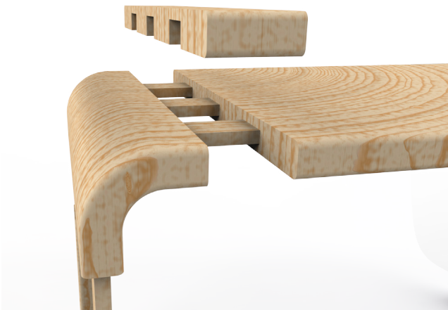
fig. 58. Encaixe dos tampos adicionais
