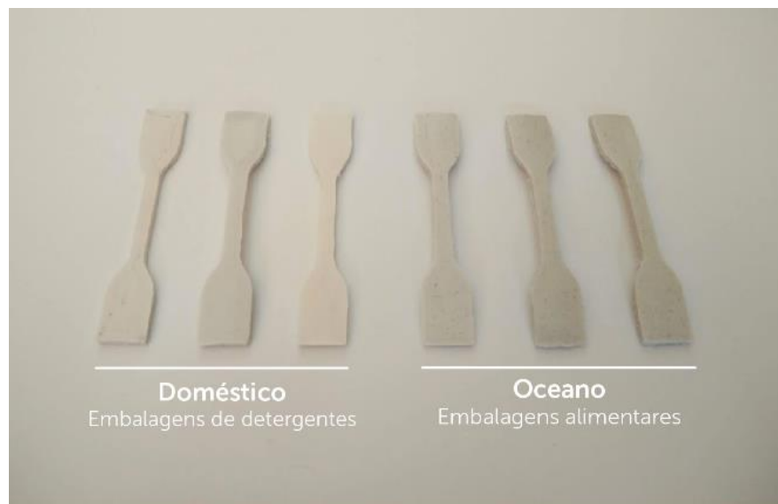
Figura 66 Amostras de provetes impressos PP
