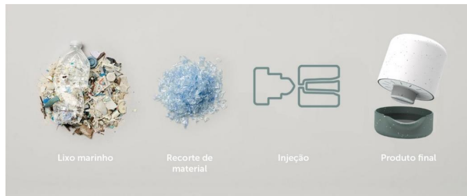
Figura 95 Processo de injeção
