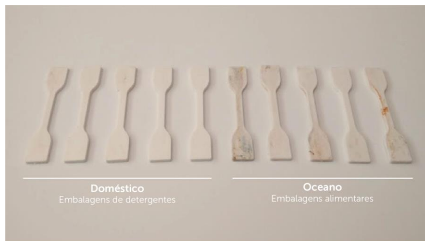
Figura 59 Amostras de provetes injetados PP
