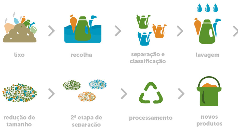
Figura 19 Fases do processo de reciclagem
