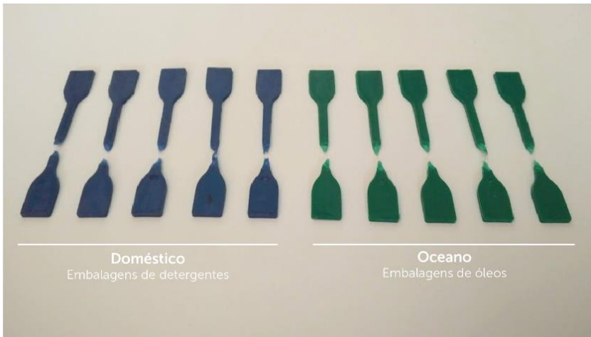
Figura 72 Amostras de provetes HDPE injetados após ensaios
