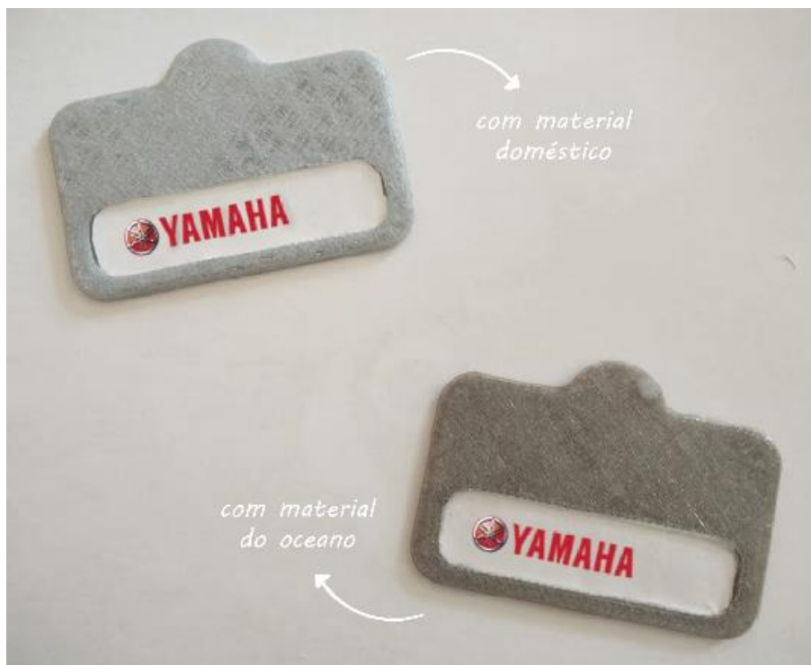
Figura 46 Identificador impresso em 3D para a Yamaha Marine
