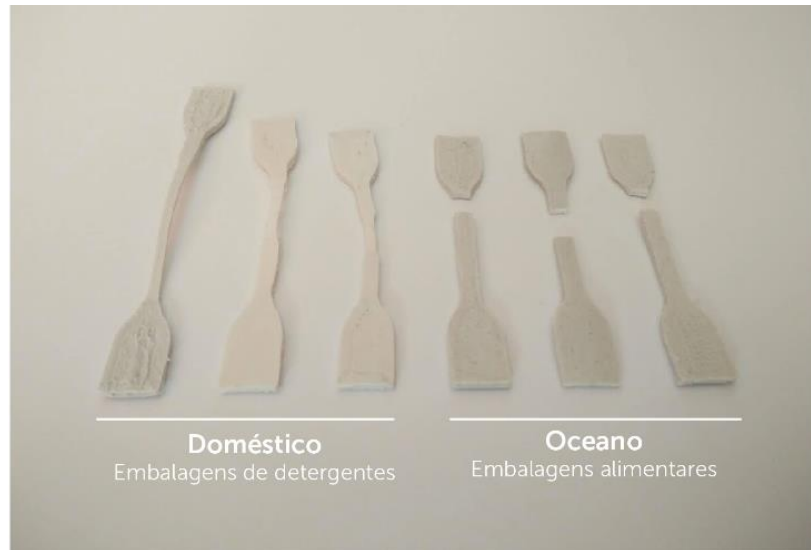
Figura 74 Amostras de provetes PP imprimidos após ensaios
