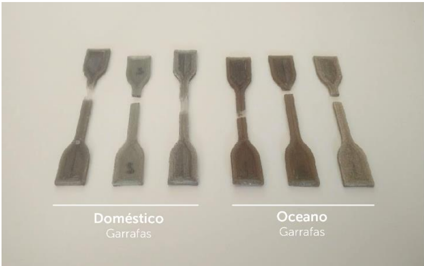
Figura 73 Amostras de provetes PET imprimidos após ensaios
