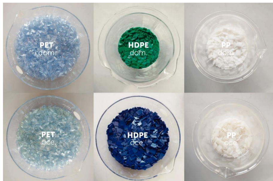
Figura 55 Redução de tamanho: PET, HDPE e PP
