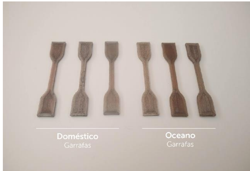
Figura 65 Amostras de provetes impressos PET
