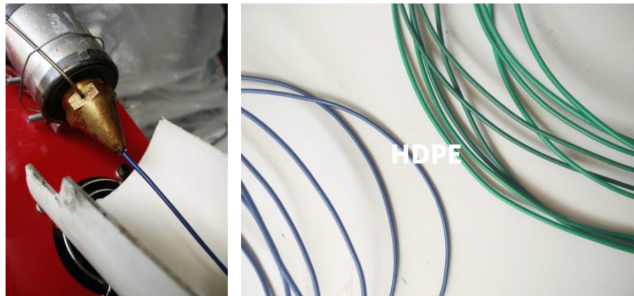
Figura 63 Extrusão de filamento de material HDPE
