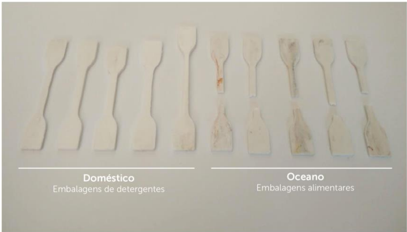
Figura 71 Amostras de provetes PP injetados após ensaios
