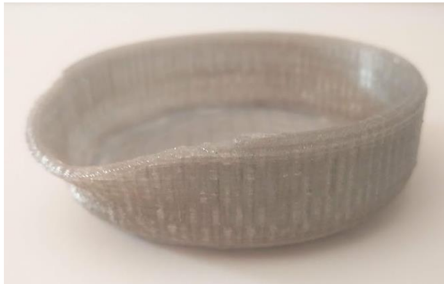
Figura 100 Componente impresso através de filamento reciclado
