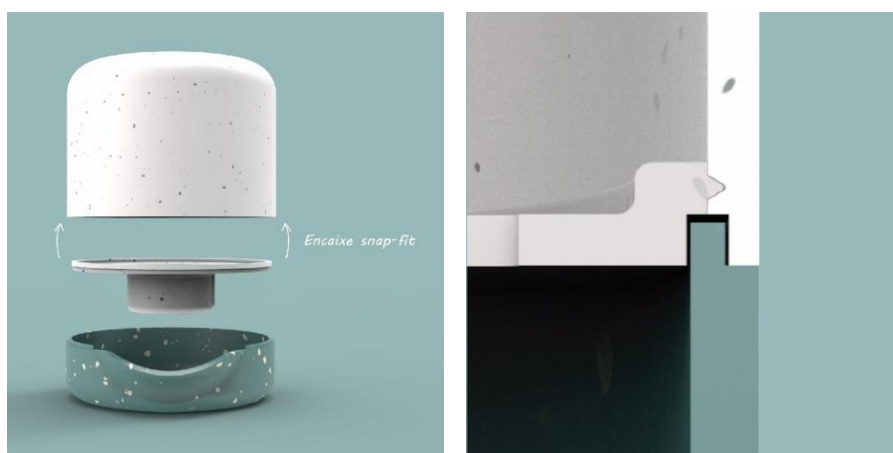
Figura 94 Componentes do produto e encaixe entre peças
