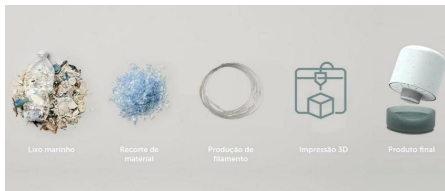
Figura 96 Processo de impressão 3D
