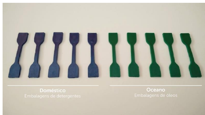
Figura 60 Amostras de provetes injetados HDPE
