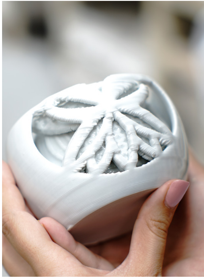
Figura 96 - Ensaio J após a segunda cozedura, com vidrado: pormenor das pétalas inferiores.
