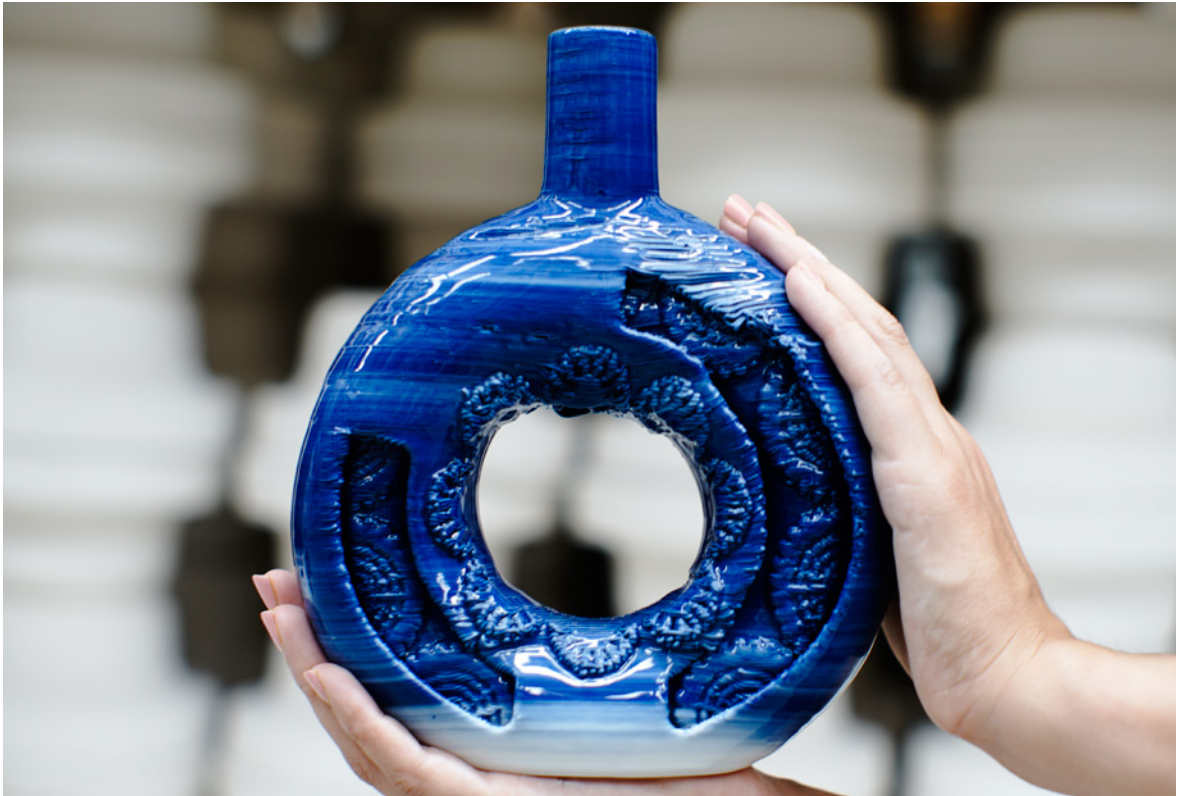
Figura 113 - Peça 2 com junção de pasta de porcelana branca e azul, após cozedura e vidrada.
