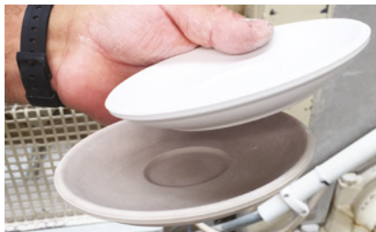
Figura 27 - Comparação de peça em verde (baixo) e peça após secagem (cima).
