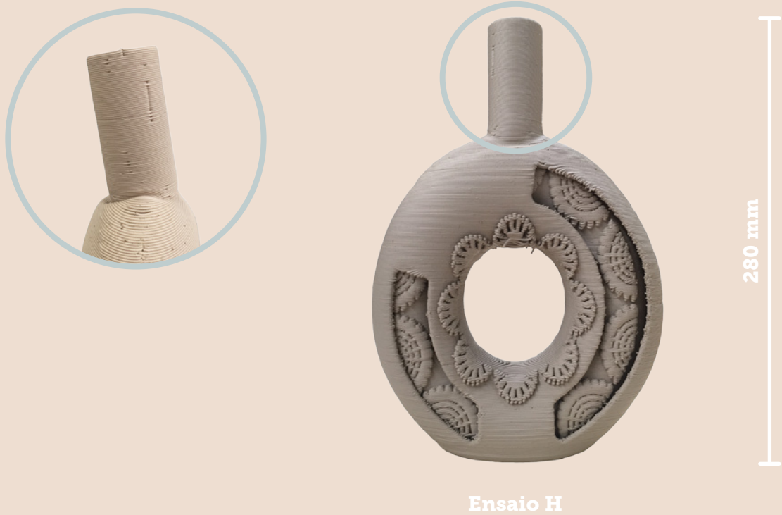
Figura 102 - Ensaio H, com as compensações feitas ao desenho.
