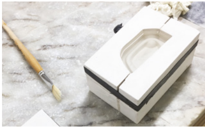
Figura 19 - Cortador: enchimento com araldite, num molde em gesso olafdur.
