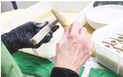
Figura 24 - Acabamento das asas.
