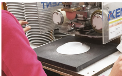
Figura 37 - Colocação do carimbo por tampografia.
