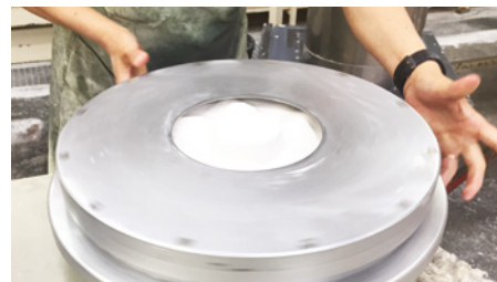
Figura 18 - Agitação, para prevenir a criação de bolhas de ar.
