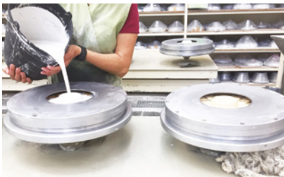
Figura 15 - Enchimento da madre com gesso.
