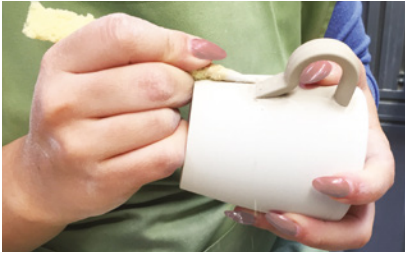
Figura 32 - Acabamento manual de asas.
