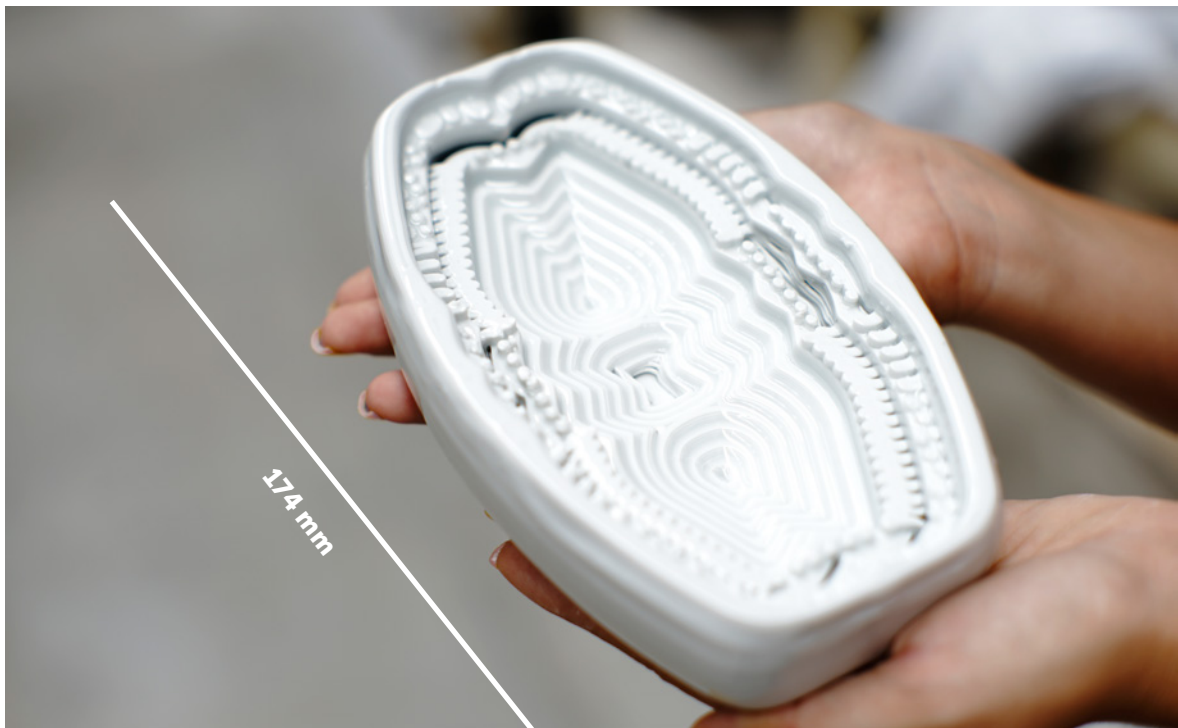
Figura 122 - Ensaio E, após a cozedura, com vidrado.
