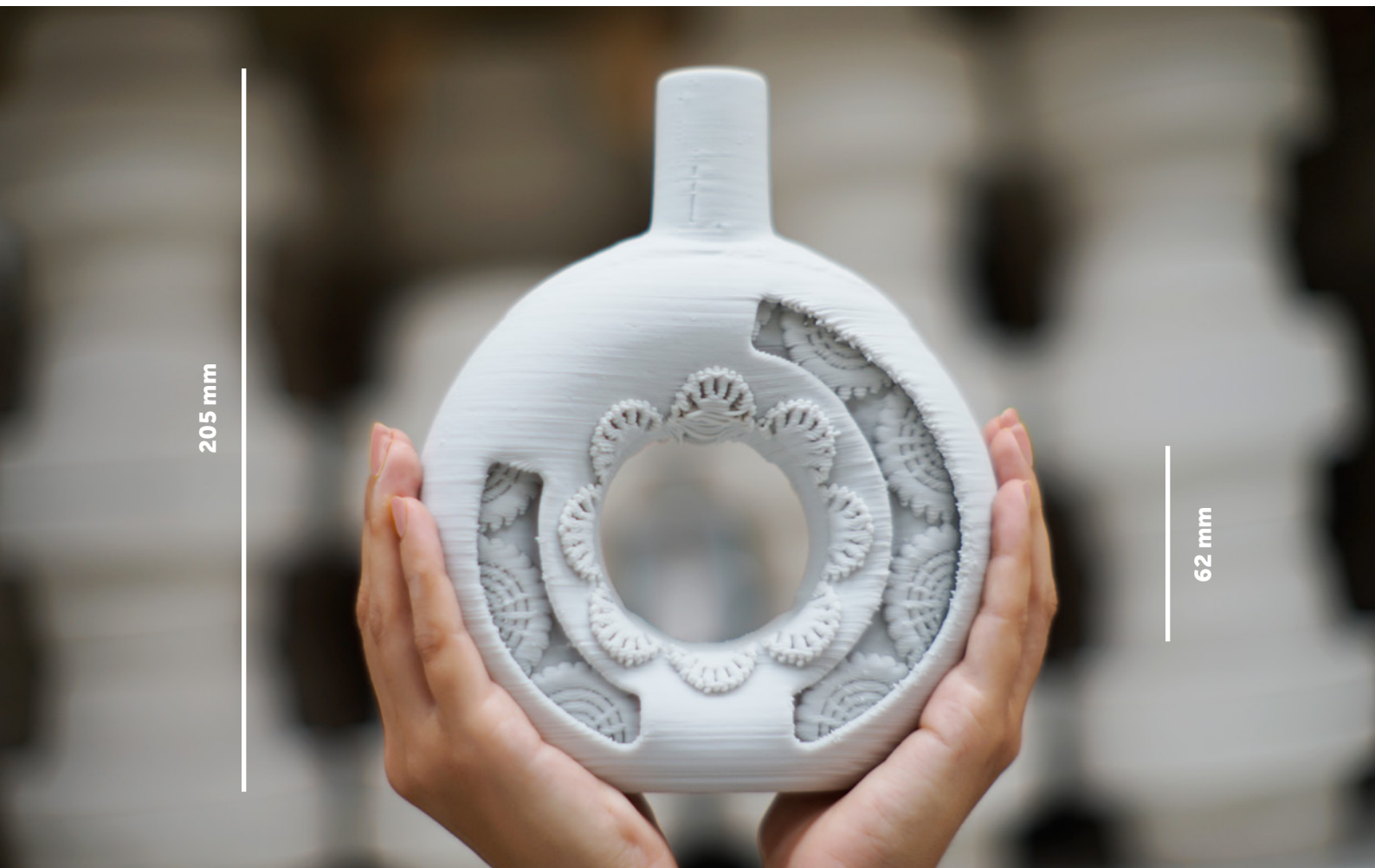
Figura 106 - Ensaio I, após a segunda cozedura, em biscuit : vista frontal com medidas finais.
