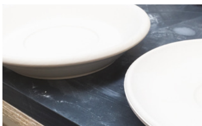
Figura 28 - Comparação de prato acabado (esquerda) e prato com rebarbas (direita).
