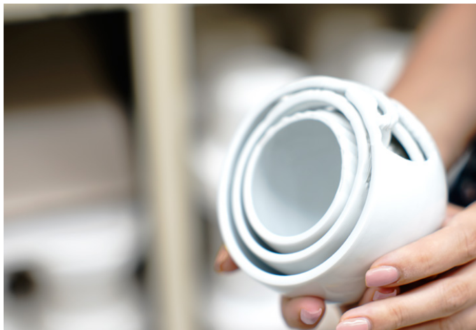
Figura 94 - Ensaio J após a segunda cozedura, com vidrado: pormenor das peças encapsuladas.
