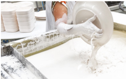
Figura 33 - Vidragem manual por mergulho.
