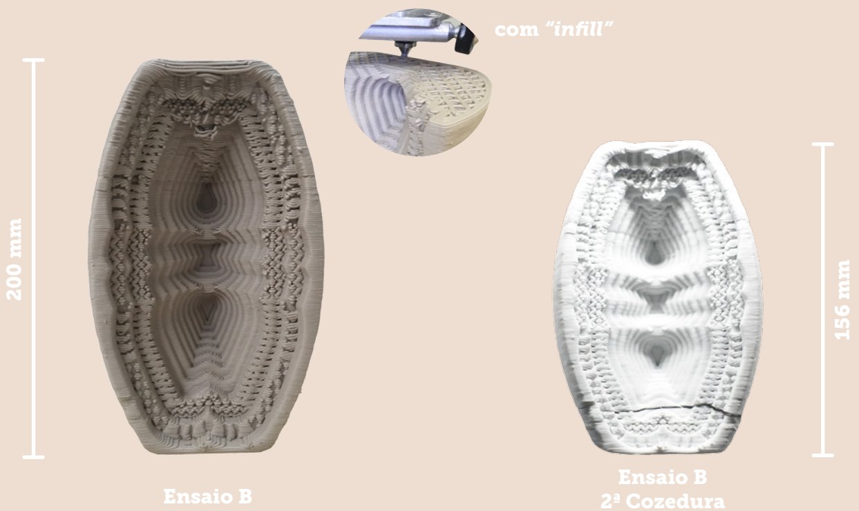
Figura 118 - Ensaio B da peça 3: comparação entre os resultados da impressão e da segunda cozedura.
