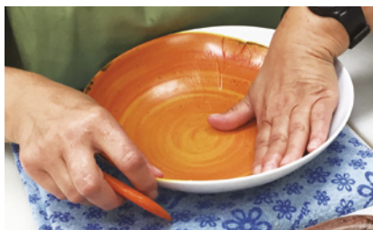
Figura 36 - Decoração por decalque.
