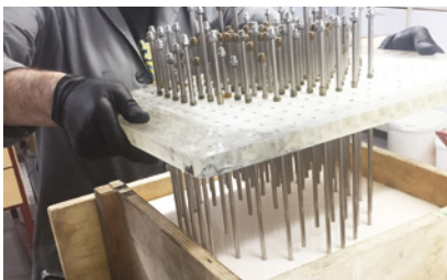
Figura 17 - Colocação das guias de entrada de ar.
