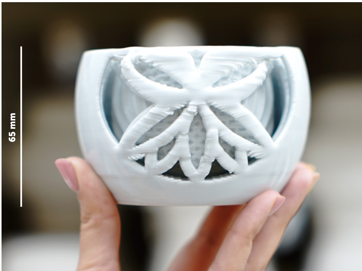
Figura 93 - Ensaio J após a segunda cozedura, com vidrado: vista frontal.
