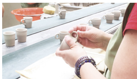
Figura 29 - Colagem manual de asas.
