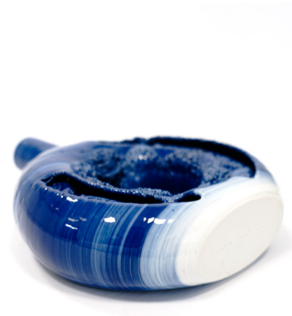
Figura 113 - Peça 2 com junção de pasta de porcelana branca e azul, após cozedura e vidrada.
