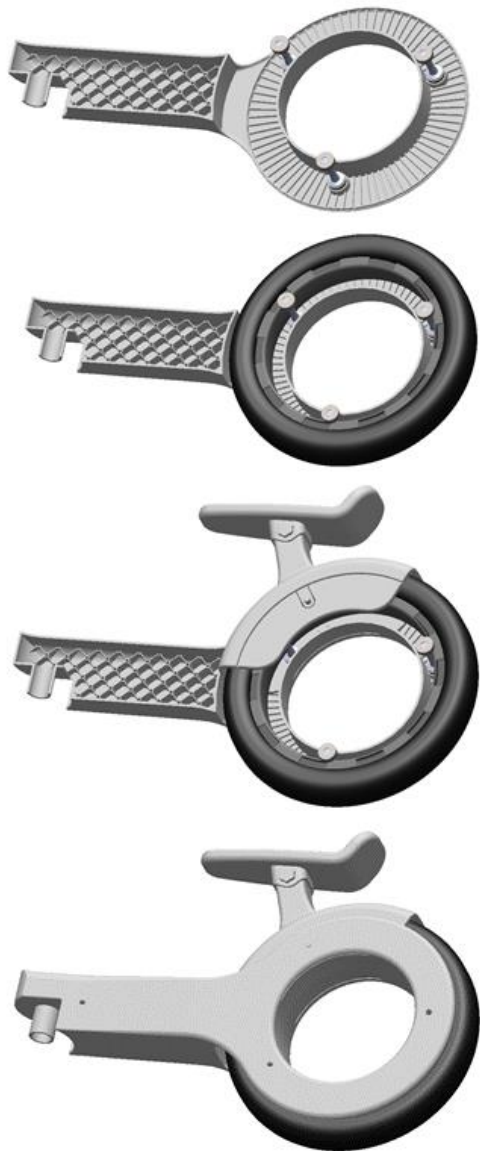
Figura 102 - Montagem da roda de trás.
