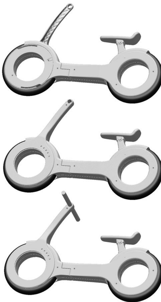
Figura 104 - Montagem da forqueta.
