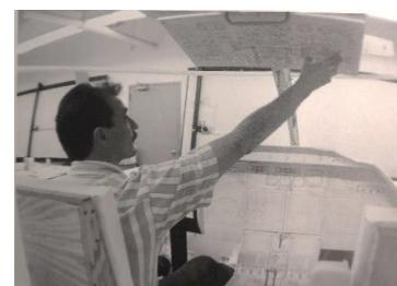
Figura 10 - Testes de utilização em mockups (fonte: Tilley, 2002).
