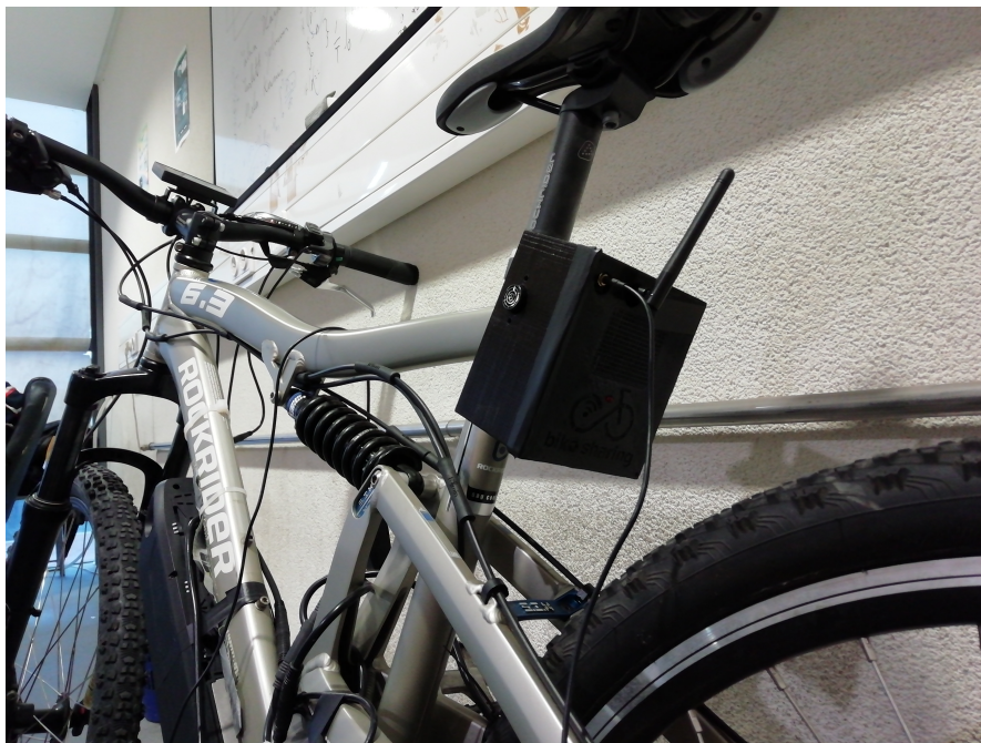
Figura 4.40: Acoplamento da componente móvel à bicicleta de testes
