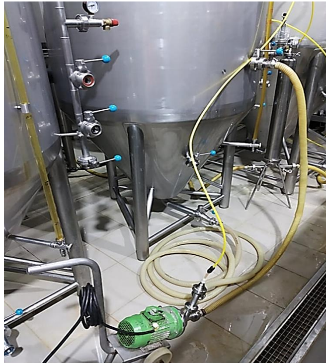
Figura 16: Sistema de carbonatação utilizado na empresa.
