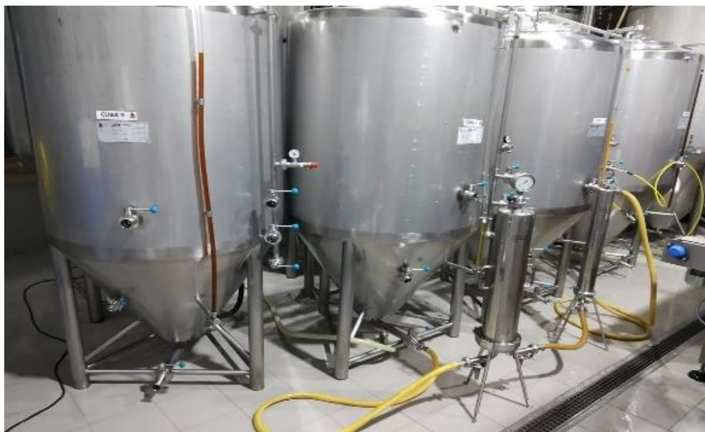
Figura 15: Sistema de filtração utilizado na empresa.
