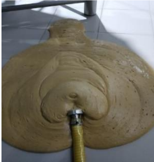
Figura 19: Remoção da levedura do mosto, através de uma purga de levedura.
