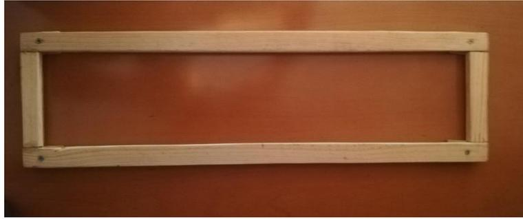
**Figura 14 – Suporte utilizado para ajudar a um registo uniforme dos valores de capacitância.**
