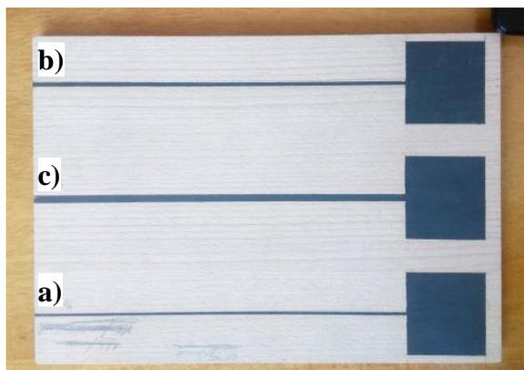
Figura 25 – Amostras utilizadas para o registo da variação da espessura do traço condutor: a) – 1 mm; b) – 2 mm e c) – 4 mm.
