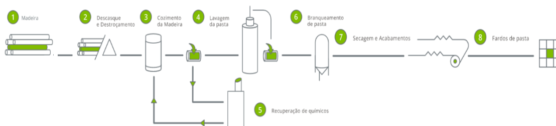
Figura 8- Etapas do processo produtivo da pasta solúvel na indústria Caima, S.A.
