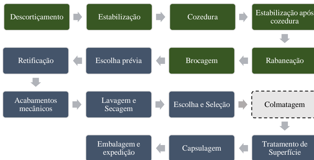
Figura 10 - Esquema do processo de produção de rolhas de cortiça.
