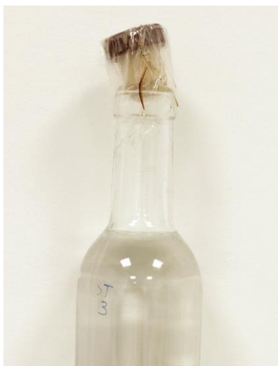
Figura 37 - Fenómeno observado nas rolhas sem tratamento de superfície durante o ensaio de envelhecimento acelerado.
