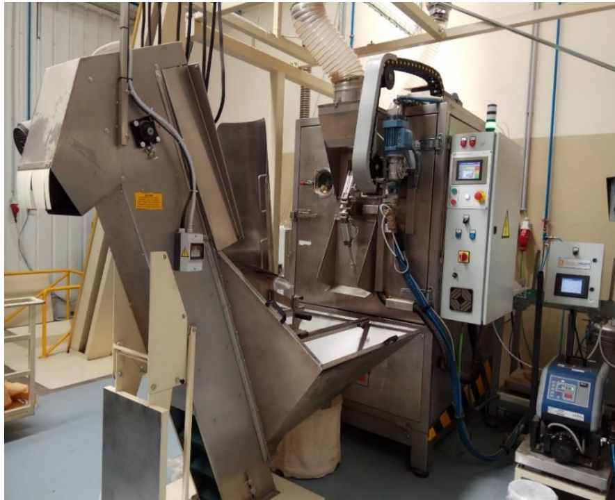
Figura 16 - Equipamento utilizado para a aplicação dos tratamentos de superfície à base de elastómeros de silicone e de parafinas.
