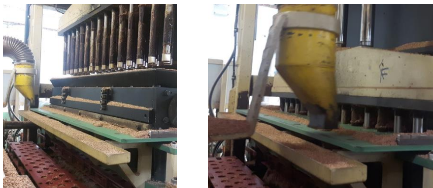
Figura 17 – Pistões móveis inseridos na moldadora, para realizar a compressão da mistura nos moldes.
