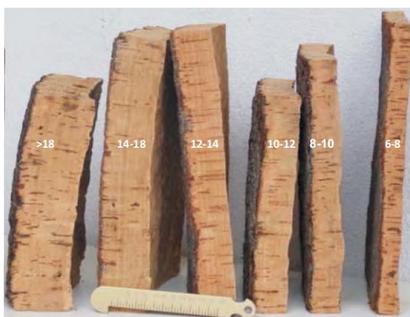
Figura 12 – Pranchas de cortiça de diversos calibres e tira-linhas (instrumento de medição). [11]
