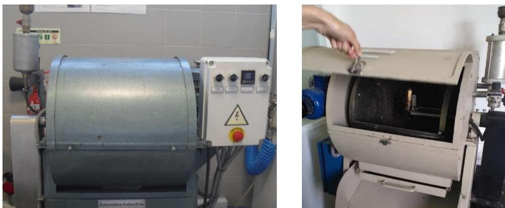
Figura 25 – Tambor laboratorial de tratamento de superfície e o seu interior.
