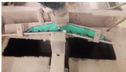
Figura 16 – Entrada de cola no misturador da moldadora.
