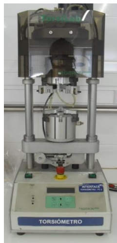
Figura 30 – Instrumento usado para o ensaio de torção (Torsiómetro).
