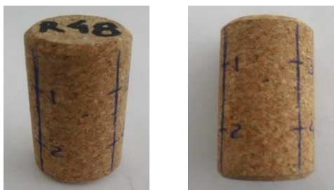
Figura 26 – Imagem de uma rolha em que foram marcados os 4 pontos de medição do diâmetro.
