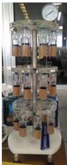
Figura 33 – Carrossel de vedação, usado no teste de vedação em tubo.
