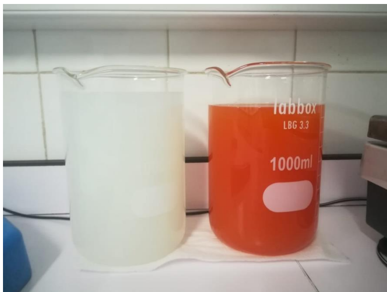
Figura 6 - Testes de Tira-Gorduras incompleto (sem a adição de corante e composto alcoólico no lado esquerdo, e sem a adição do composto alcoólico no lado direito).
