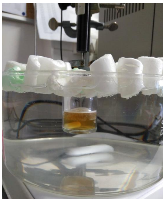
Figura 9 – Montagem experimental do processo de SPME com a fibra exposta
