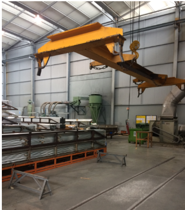
Figura 4.8: Ponte mecânica que transporta os contentores com perfis de alumínio
