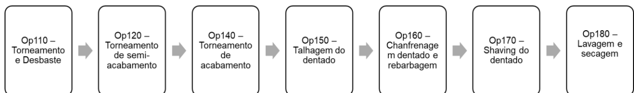
Figura 17 – Sequência da Maquinação da Coroa
