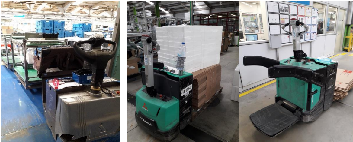
Figura 22: Comboio logístico - Stacker manual e Stacker automático
