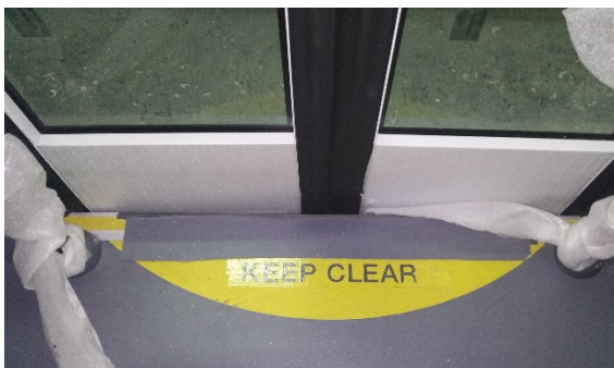
Figura 57 - Proteção dos Estribos.
