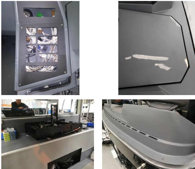
Figura 23 - Riscos/Mossas na Cabine.
