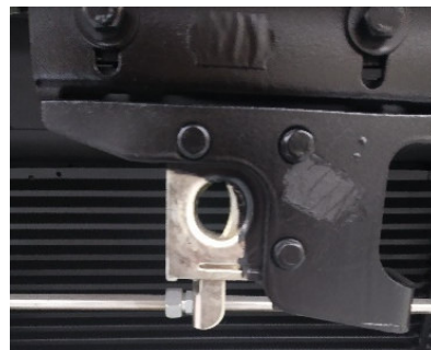
Figura 18 - Excesso de Tinta.
