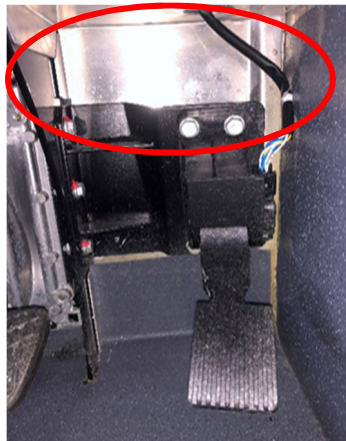
Figura 60 - Chapa dos Pedais sem Tinta.
