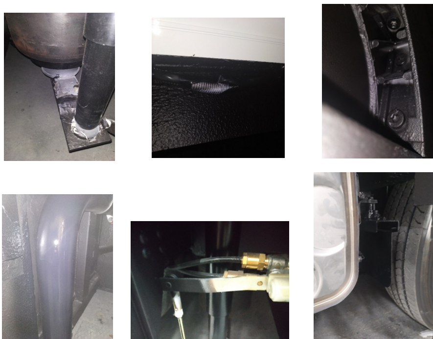
Figura 72 - Falhas de Tinta nos Componentes no Interior das Tampas.
