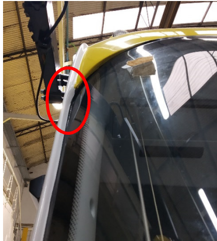
Figura 56 - Cola na Frente do Autocarro.
