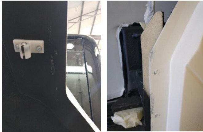
Figura 24 - Pintura Danificada na Tampa Traseira.
