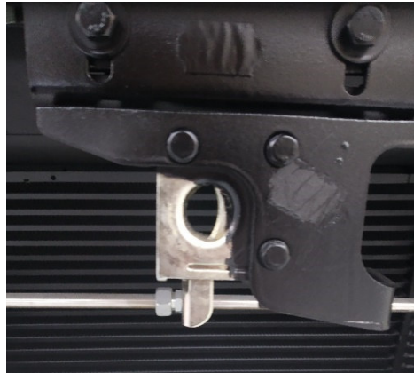
Figura 73 - Tinta no Suporte do Fecho.
