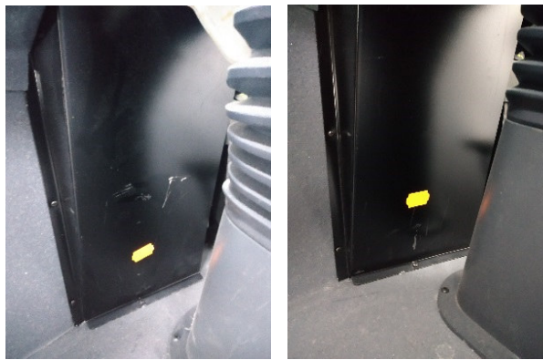
Figura 67 - Chapa da Coluna de Direção Riscada.
