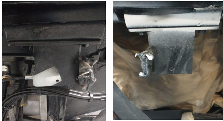
Figura 26 - Falhas de Tinta.
