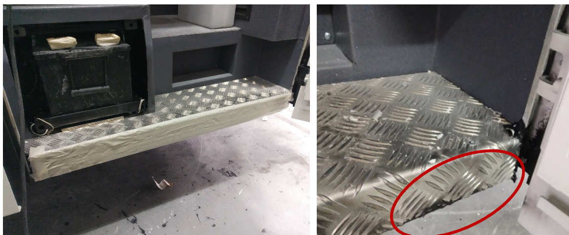
Figura 25 – Tinta Ft 90 nos Estribos.
