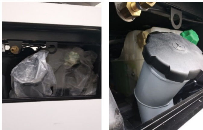
Figura 63 - Isolamento do Depósito do Gasóleo com Plástico.
