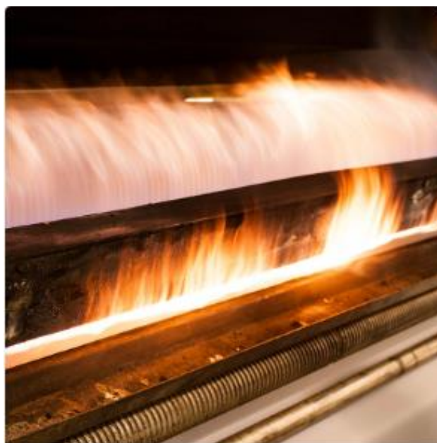
Figura 4: Laminação a quente
