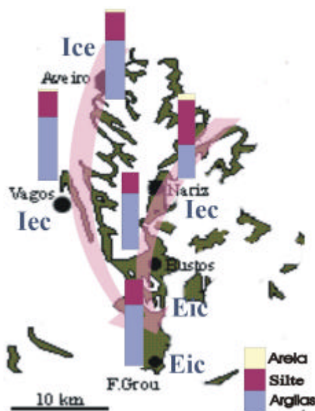
Figura 7.18 - Variação espacial da relação da dimensão do grão e dos minerais argilosos das argilas da unidade litoestratigráfica “Argilas de Aveiro” . I – illite, C – caulinite e E – esmectite e interestratificados 10 – 14 Å.
