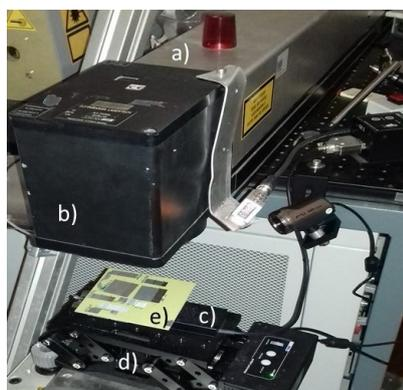
Figura 3.2: Fotografia do sistema utilizado: a) laser; b) cabeça galvanométrica; c) mesa móvel; d) provete.
