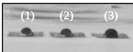
Figura 3.3: Imagem das três amostras processadas com a pasta de ZnO utilizando os parâmetros de processamento: v=200\text{ mm}\cdot\text{s}^{-1} , P=21\text{ W} , d=0,1\text{ mm} , h_{laser}=2,1\text{ cm} , onde os ângulos de contacto são: (1) 105,85^\circ , (2) 107,47^\circ e (3) 95,23^\circ .
