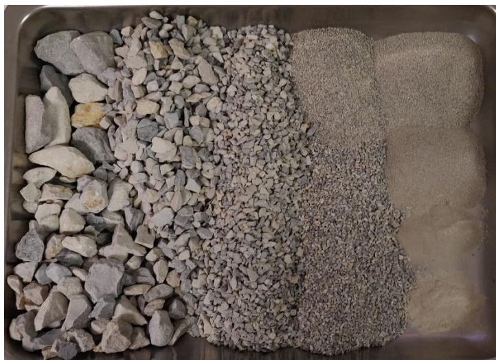
Figura 23 - Amostra da granulometria do tout-venant 2 (cinzento)
