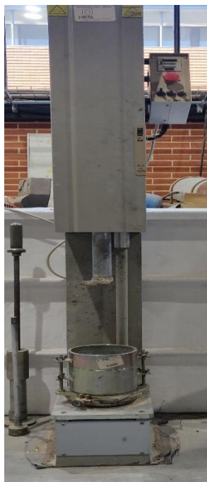
Figura 21 – Instrumento usado na realização do ensaio de compactação
