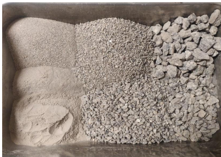
Figura 28 - Amostra da granulometria da MB da camada de regularização
