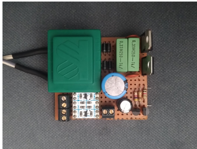
Figura 4.13: Placa de alimentação e amplificação de sinais
