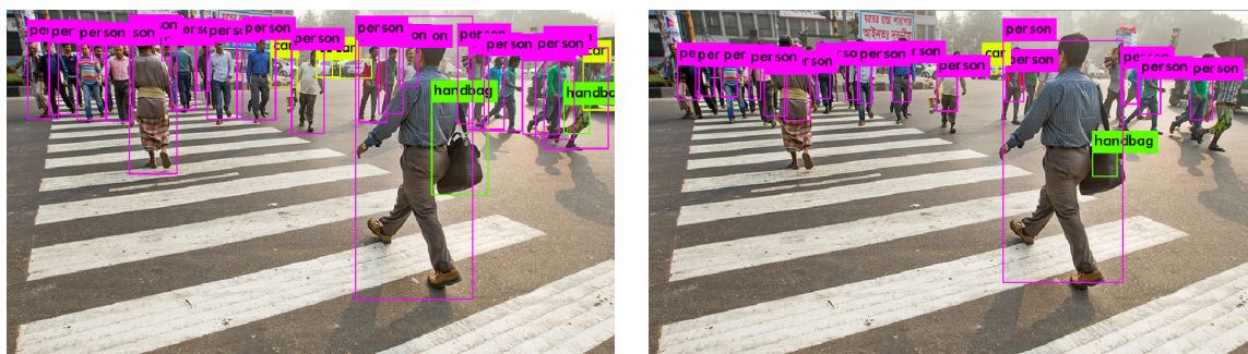
Figura 5.9: Exemplo nº2 - YOLOv3 (esquerda) vs YOLOv3-tiny (direita)
