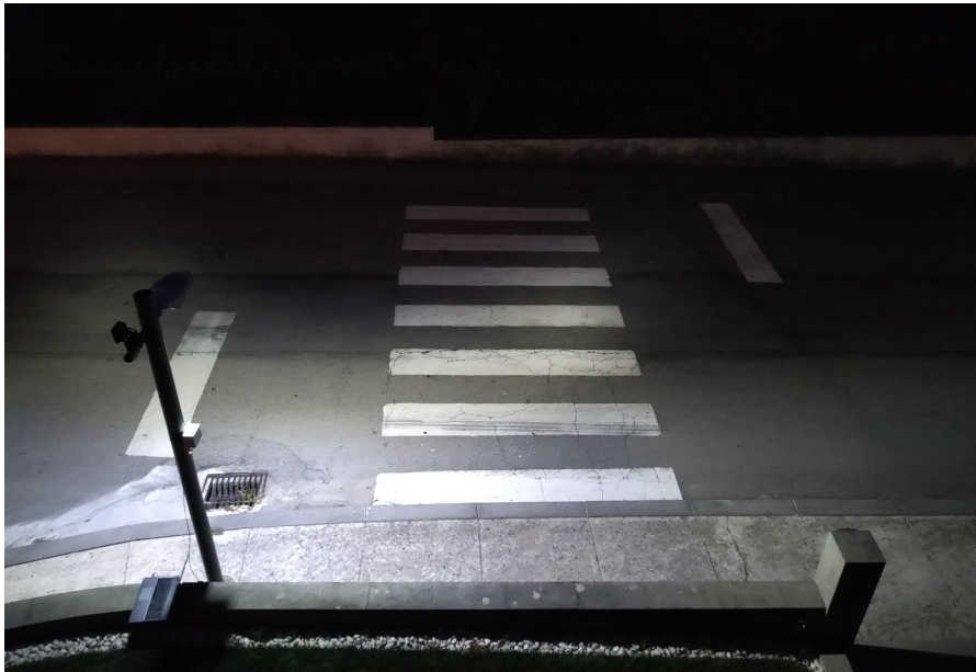
Figura 6.21: Vista de topo durante o teste de luminosidade - modo de poupança de energia
