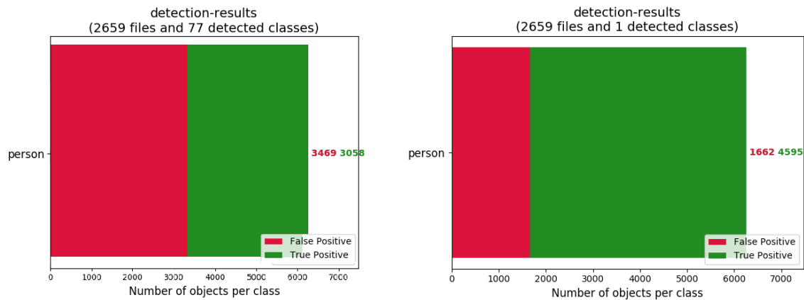
Figura 6.6: Objetos detetados: YOLOv3-tiny (esquerda) e versão melhorada (direita)
