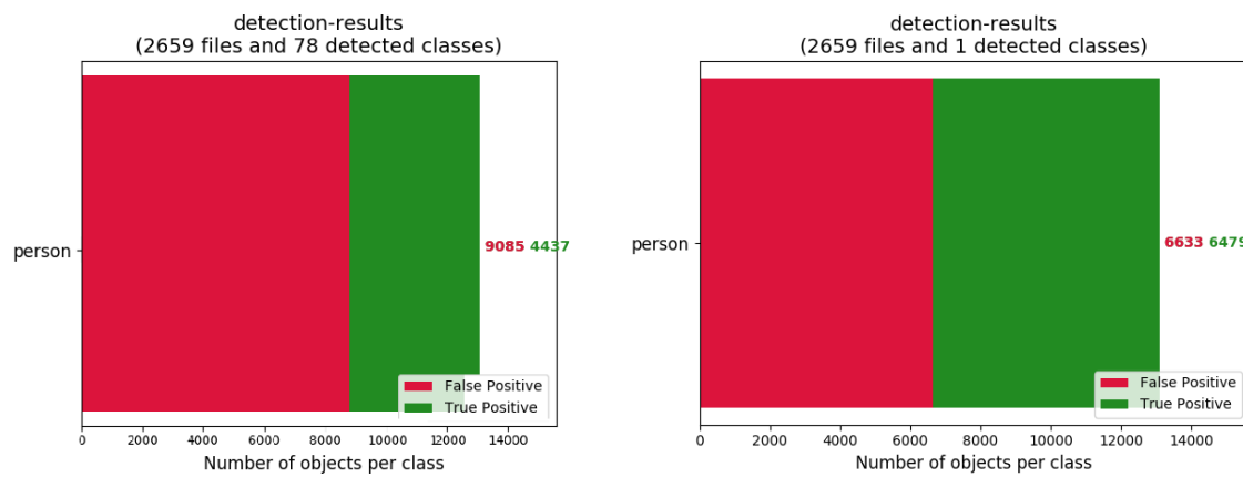
Figura 6.9: Objetos detetados: YOLOv3-tiny (esquerda) e versão melhorada (direita)
