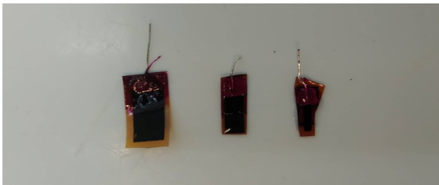
Figura 5.1: Transdutores com diferentes dimensões: 5 \times 5 \text{ mm}^2 , 3 \times 3 \text{ mm}^2 e 1 \times 1 \text{ mm}^2
