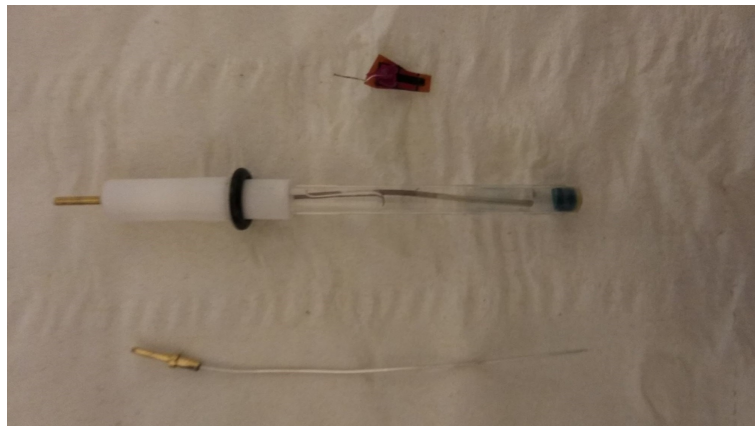
Figura 5.2: Elétrodos utilizados para aquisição dos dados: eletrodo de trabalho (no topo); eletrodo de referência (no meio) e contra-elétrodo (em baixo).
