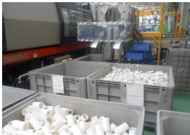
Figura 24 - Máquina de injeção a injetar componentes para os contentores de stock
